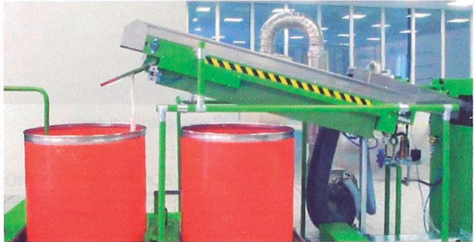
Maquina Rompedora Seydel Tachos de Salida y vaporizador
