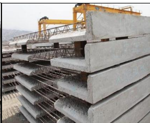
Fig. 114. prelasas acopiadas en área de stock.
