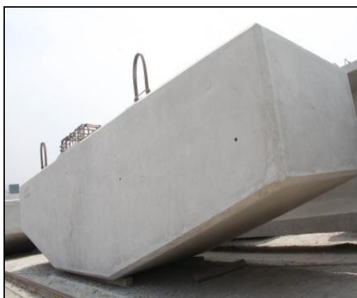
Fig. 113. Viga Cabezal en área de stock.
