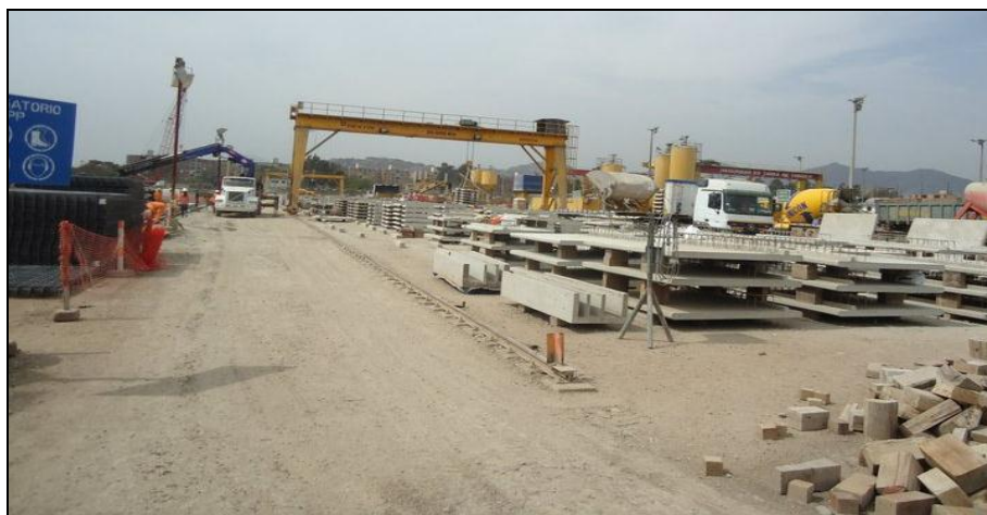
Fig. 116. Fotografía de bordes típicos y prelosas en área de stock.
