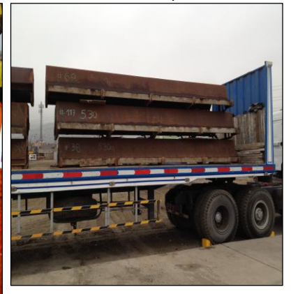
Encofrados de vigas prefabricadas
