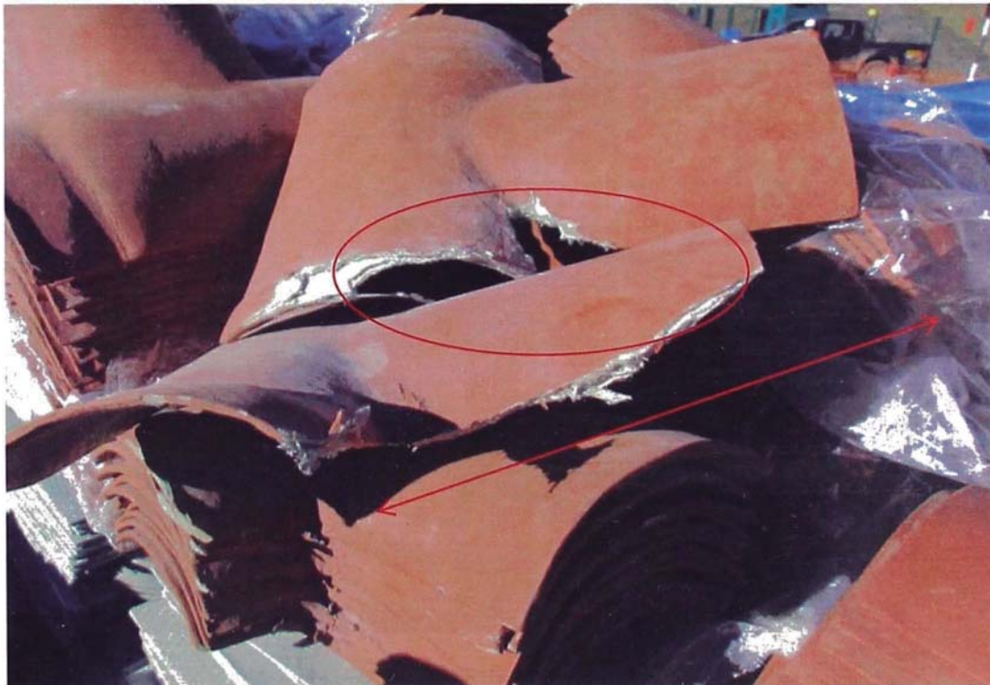
FIGURA N°. 9: TEJAS DAÑADAS.
