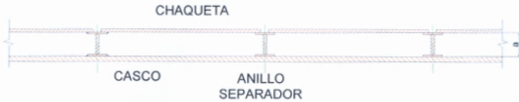
Figura 2.8. Vista en corte de la disposición de anillos separadores.
