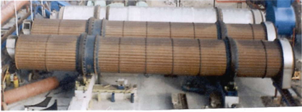
Figura 2.11 Secadores con chaqueta tipo media caña.
