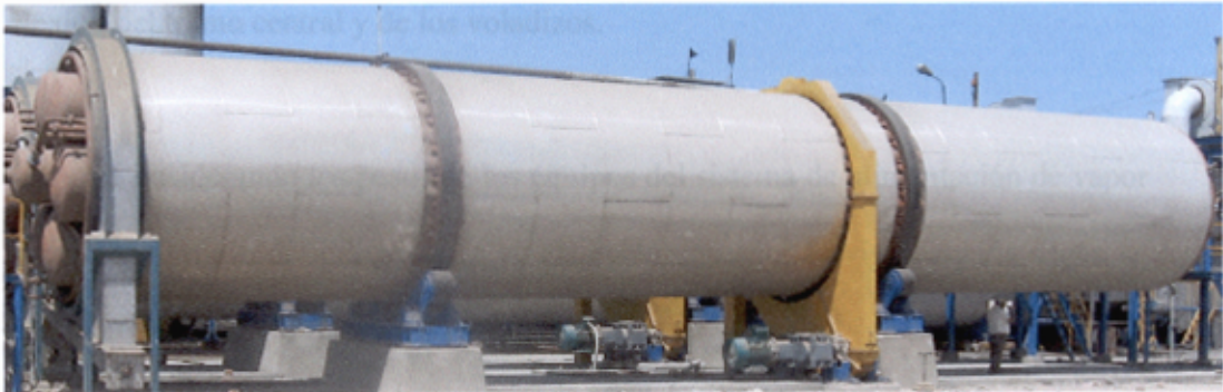
Figura 4.1 Secador con sus dos pistas de rodadura y su transmisión de potencia cadena-rueda dentada con cubierta metálica pintada de amarillo.
