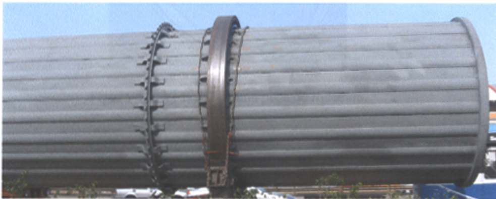
Figura 4.8 Platinas muelle de la fijación flotante de la rueda dentada y de una pista
