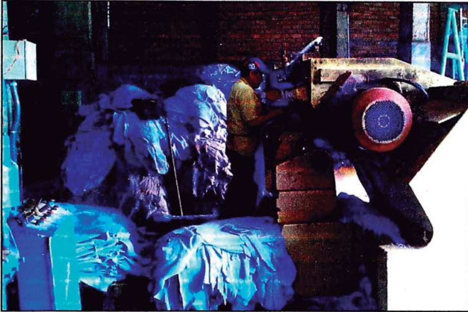
Fig. 3.23: Máquina de Rebajado, Curtiembre Vanú
