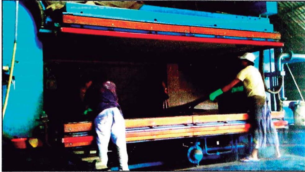
Fig. 3.26: Secado al vacío de pieles, Curtiembre Vanú
