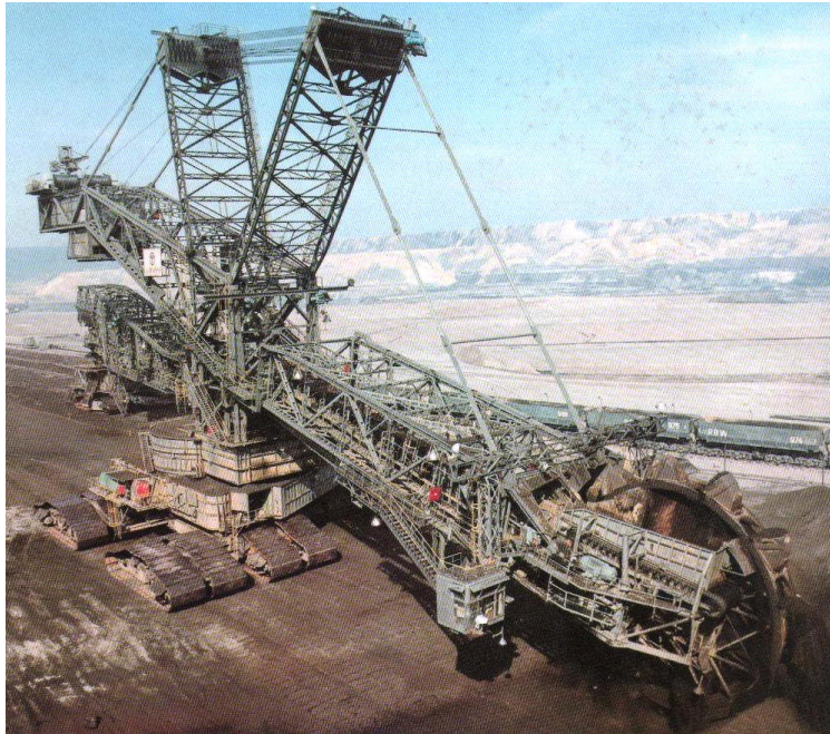
otografía N° 2-7: Rueda de cangilones GIANT de KRUPP Industrie und Stalbau, producción 240 000 m 3 /día.
