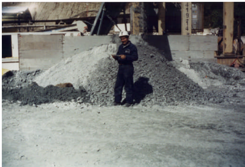
Fotografía N° 4-6: Granulometría del escombros proveniente de de roca suave tipo “CM”.
