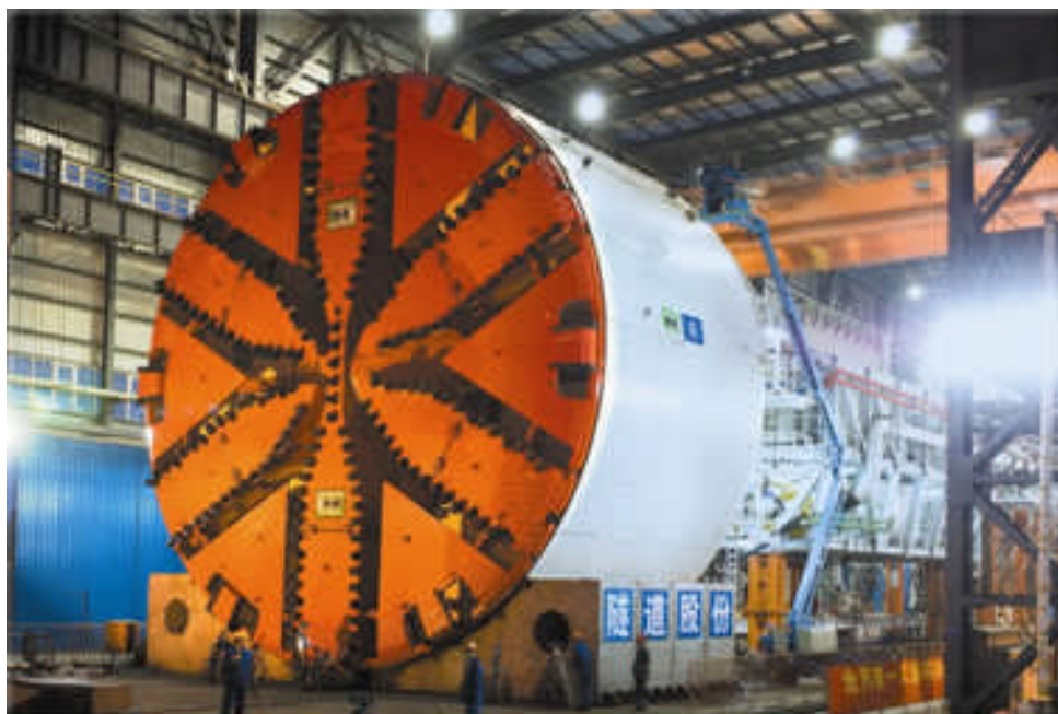
Fotografía N° 2-18: Mega “TBM” Herrenknecht “S-317” de 15,43 m de diámetro en Shanghai.
