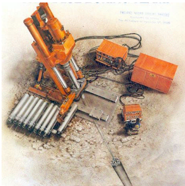
Fotografía N° 2-11: Raise Boring durante la excavación Robbins Co.
