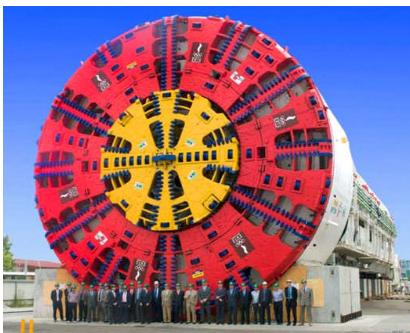
Fotografía N° 2-19: Mega “EPB TBM S-300” de 15,20 m de diámetro, construido por Herrenknecht para el túnel carretero M-30 de Madrid.
