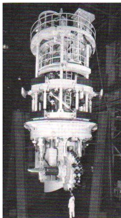
Fotografía N° 2-12: Shaft Boring de Robbins Co.
