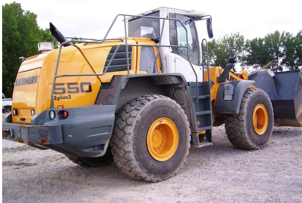
Fotografía N° 6-3: Cargador frontal LIEBHERR L550 2plus2.
