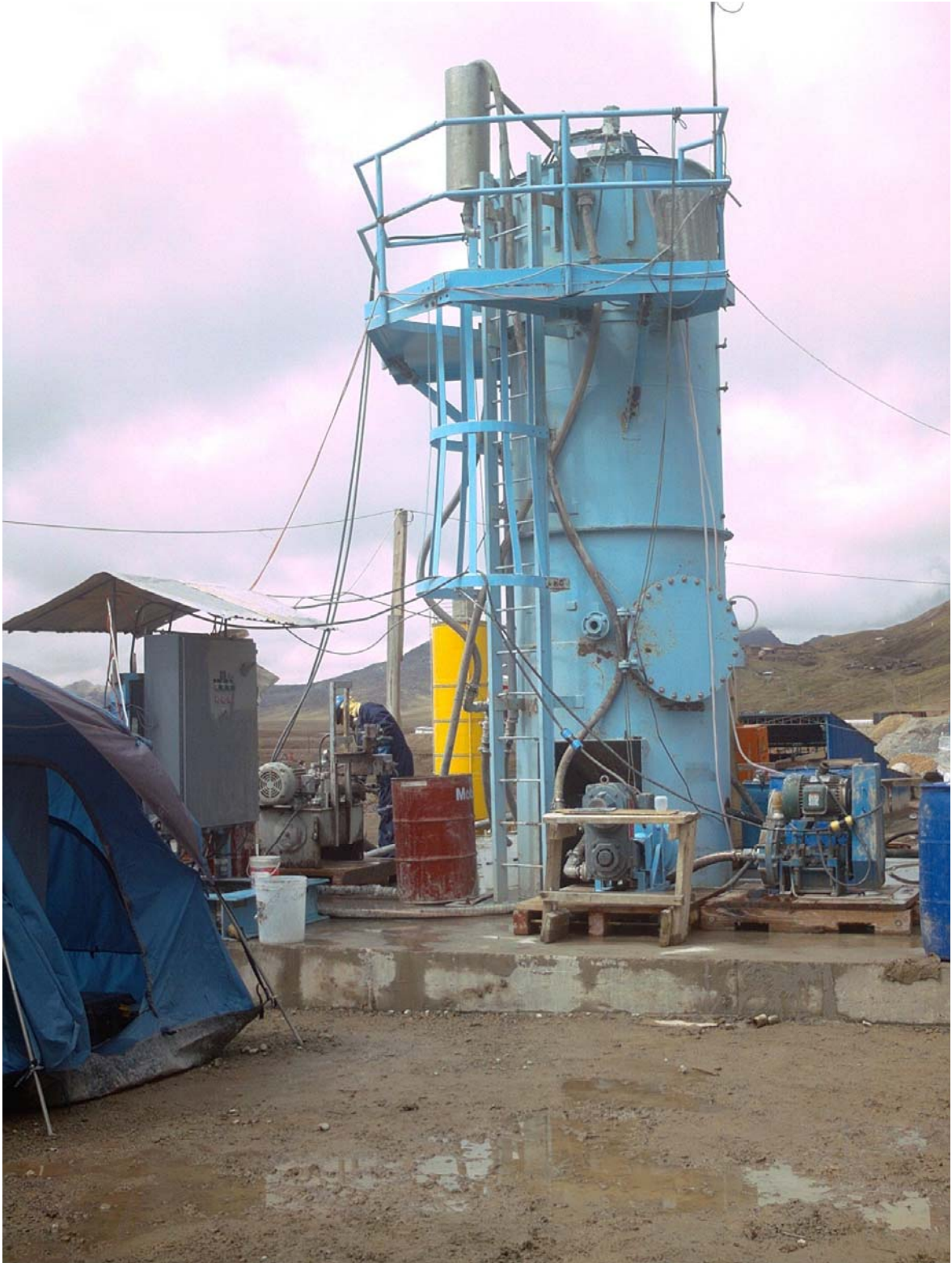
Fotografía I.1: Espesador Piloto de Cono Profundo utilizado en las pruebas de Tratamiento Integral de Aguas Residuales Industriales.
