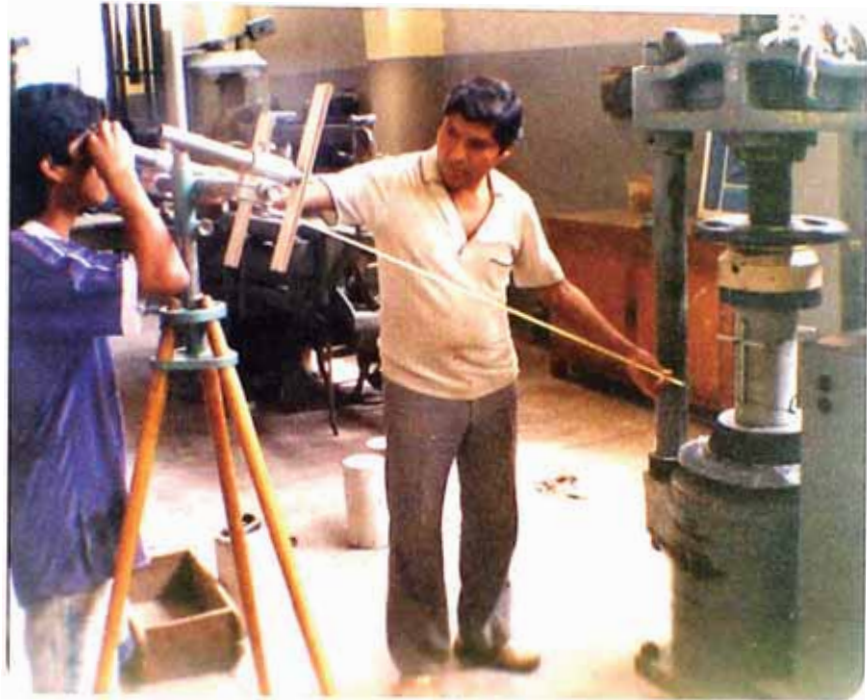
FOTO N° 24 Medición de la distancia reglamentaria (125 cm.) Ensayo de elasticidad.
