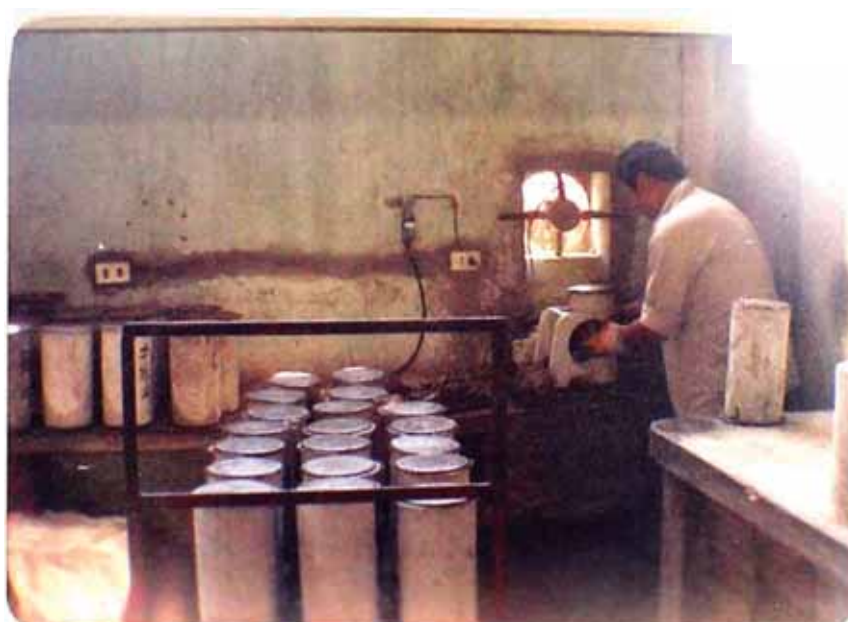
FOTO N° 23 Zona de capeado (se observa al Técnico, las probetas capeadas, la cocinilla eléctrica y el extractor de humos).
