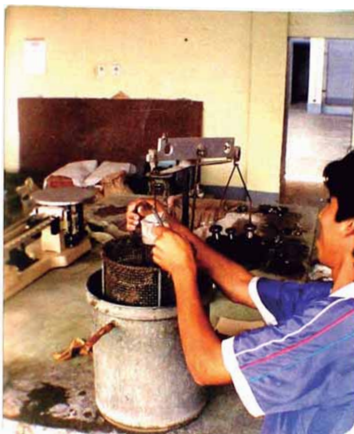
FOTO N° 14 Procedimiento de calibración de la balanza hidrostática y pesado de la canastilla para el ensayo de peso específico y absorción de la piedra.
