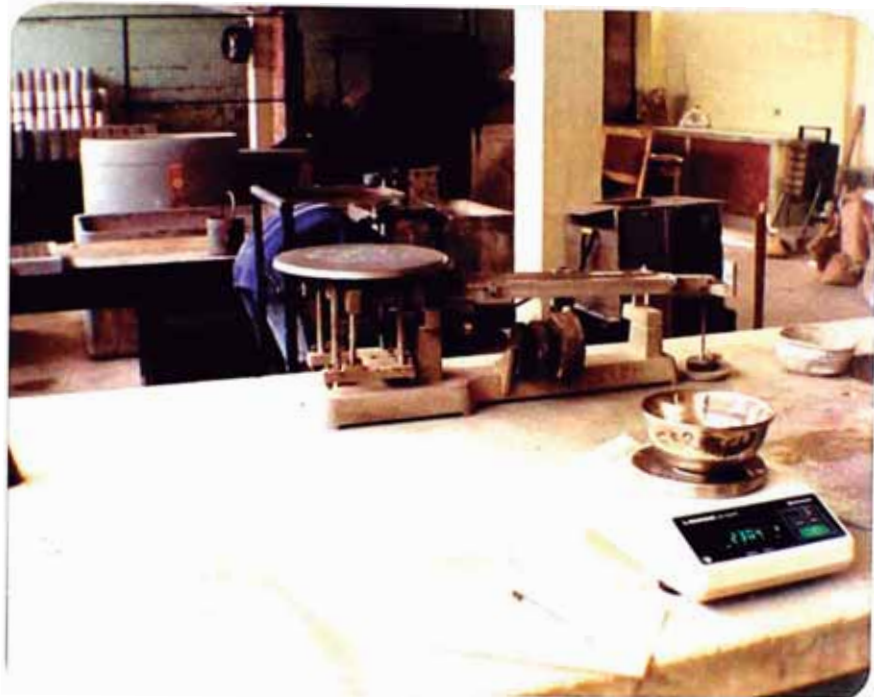
FOTO N° 6 Dos generaciones de balanzas, la mecánica y la electrónica digital.
