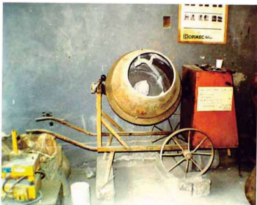
FOTO N° 27 Mezcladora de 0.06\text{m}^3 , utilizada en la Tesis.
