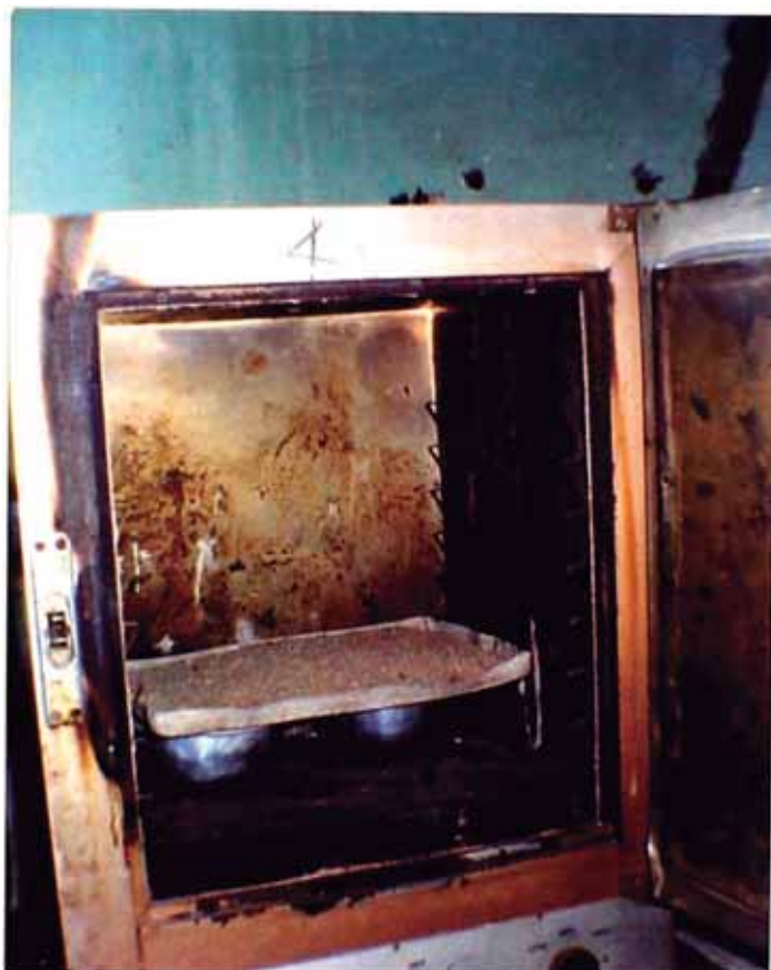
FOTO N° 10 Horno para secar los agregados (arena).
