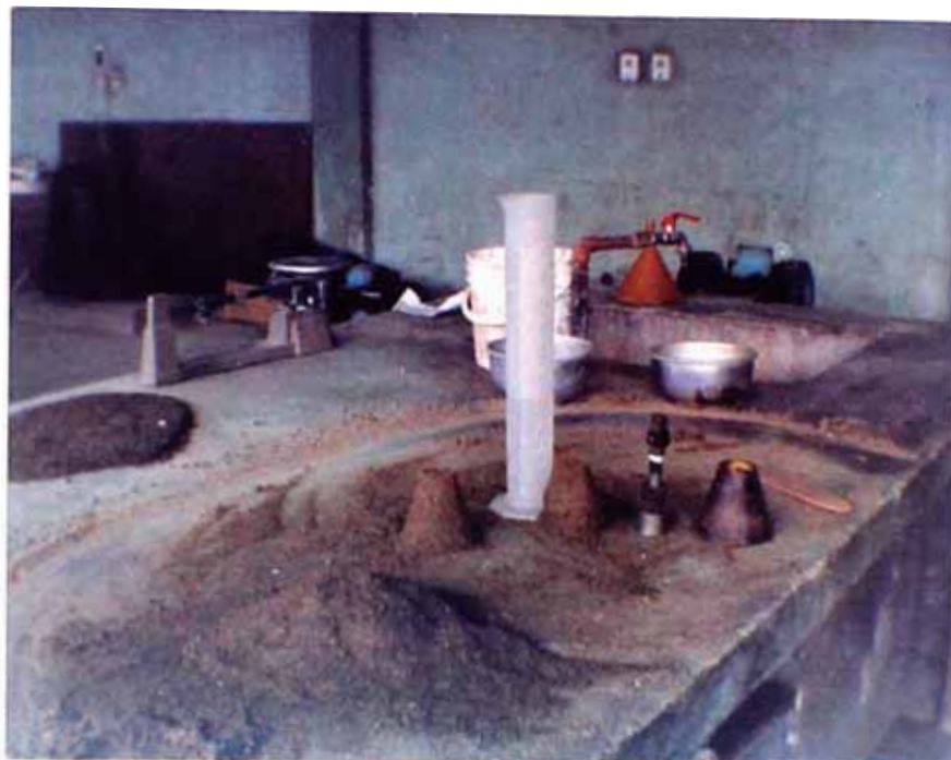
FOTO N° 13 Procedimiento para hallar el peso específico y absorción de la arena (mediante la probeta graduada).
