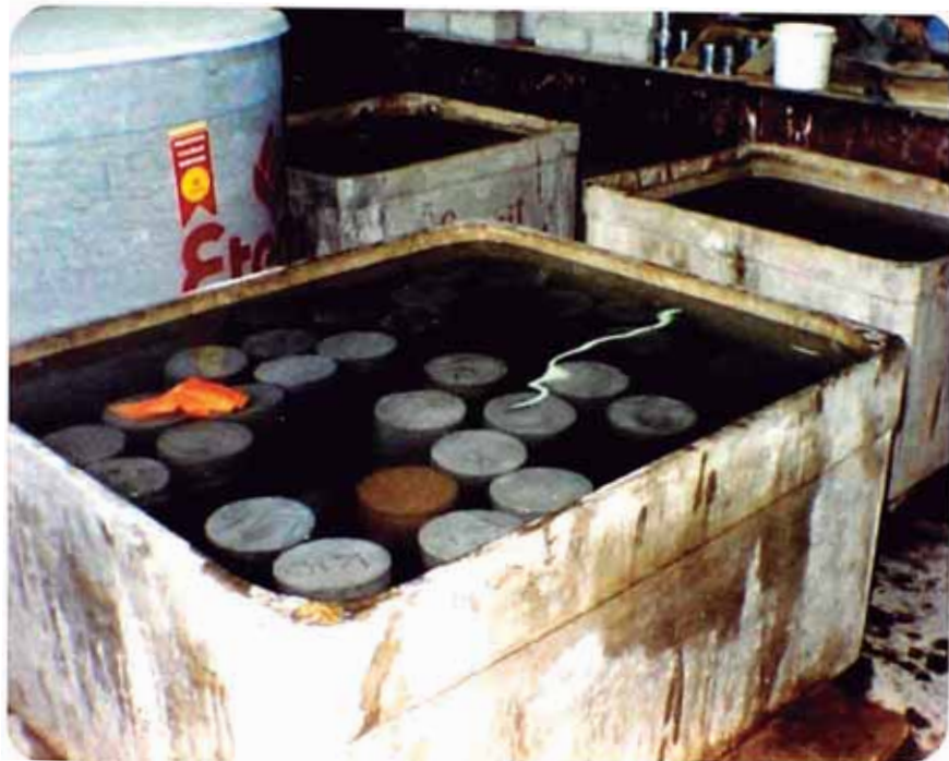
FOTO N° 20 Pozas de curado de las probetas.
