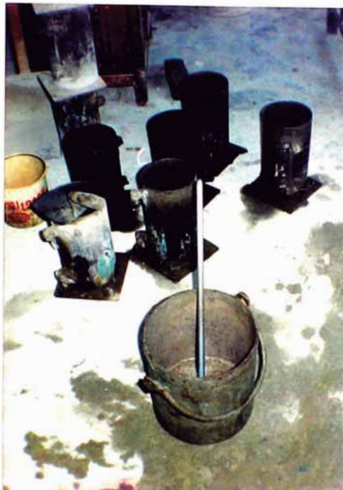
FOTO N° 11 Recipiente de acero de 1/2 pie cúbico de capacidad, varilla de 60 cm., diámetro 5/8" punta roma (ensayos de agregados y concreto).
