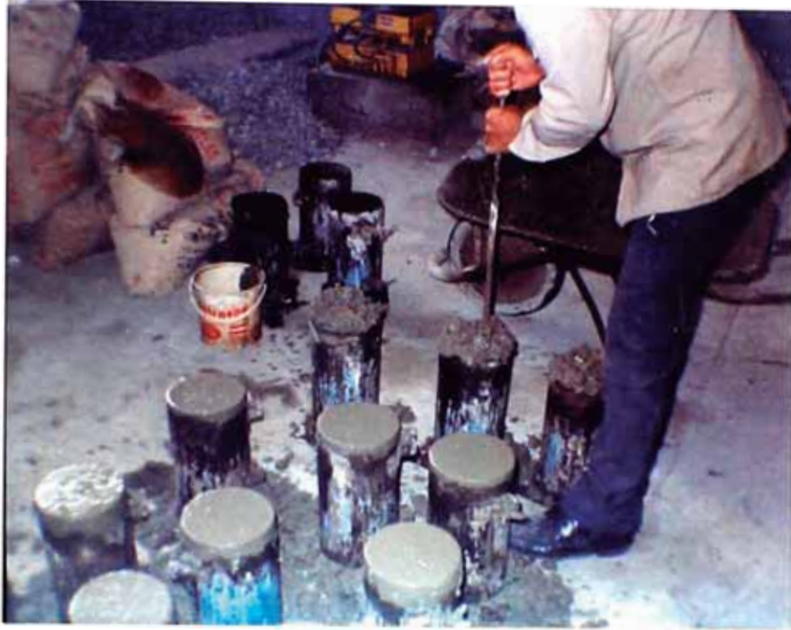
FOTO N° 18 Llenado de la tercera capa de concreto en el molde de acero.
