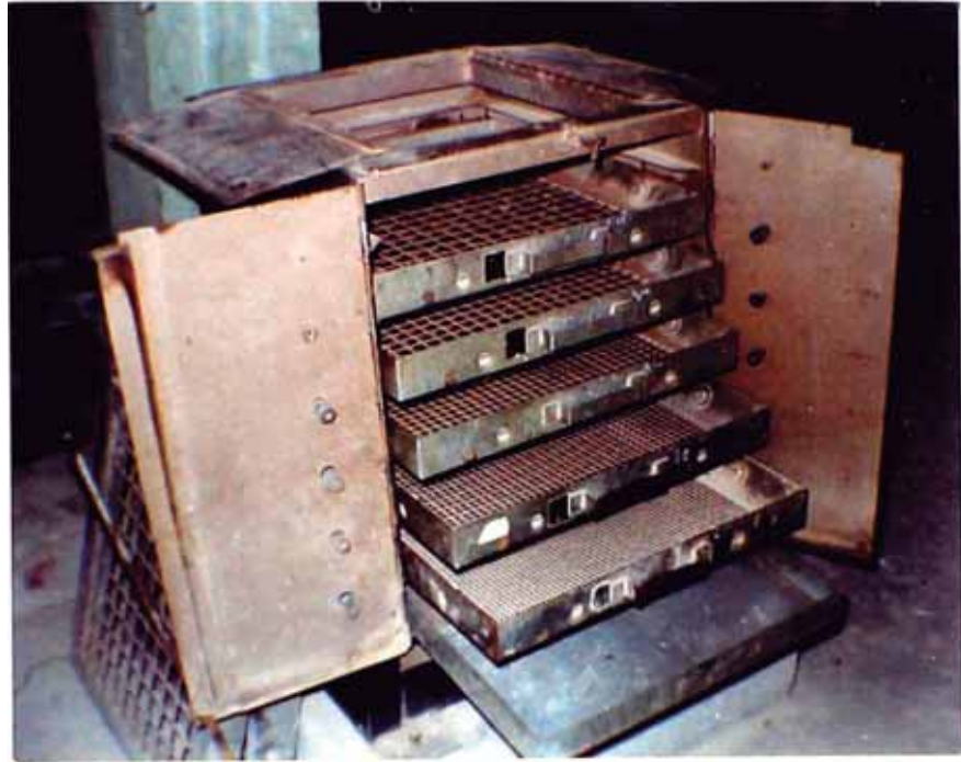
FOTO N° 9 Máquina y mallas para hacer el análisis granulométrico de la piedra (agregado grueso).
