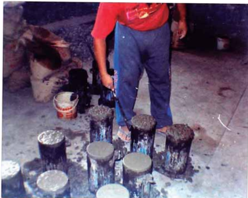
FOTO N° 19 Terminado y acabado de los moldes llenos de concreto.
