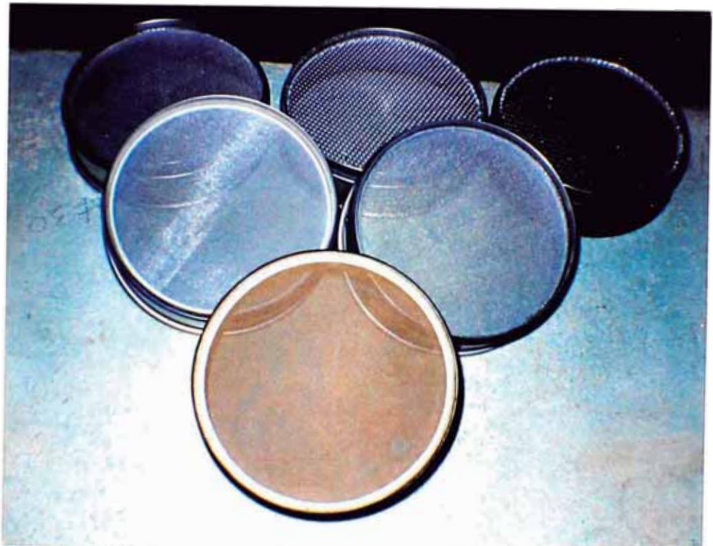
FOTO N° 8 Tamices para hacer el análisis granulométrico de la arena (agregado fino).
