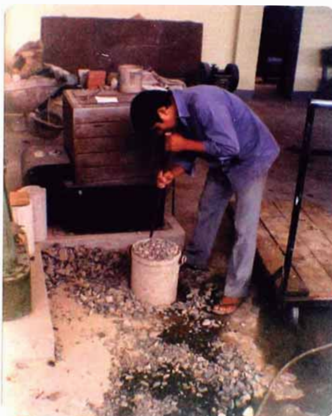
FOTO N° 12 Procedimiento para hallar el peso unitario compactado de la piedra.
