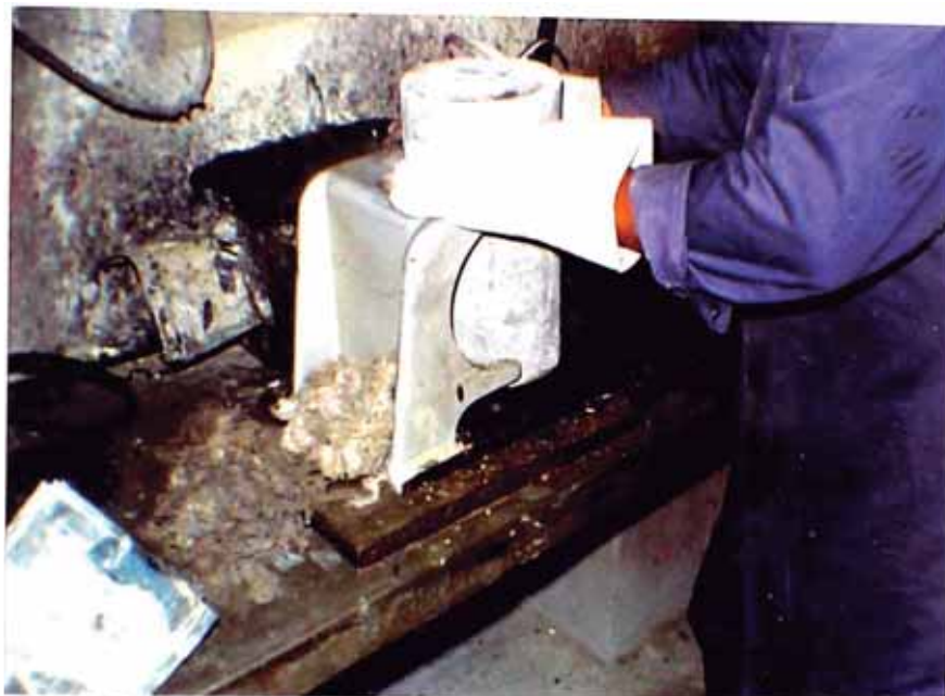
FOTO N° 21 Procedimiento de capeado de la parte superior de la probeta cilíndrica.
