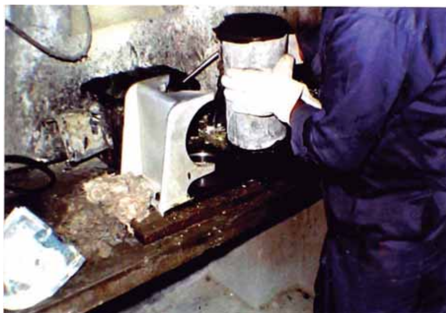
FOTO N° 22 Procedimiento de capeado de la parte inferior de la probeta cilíndrica
