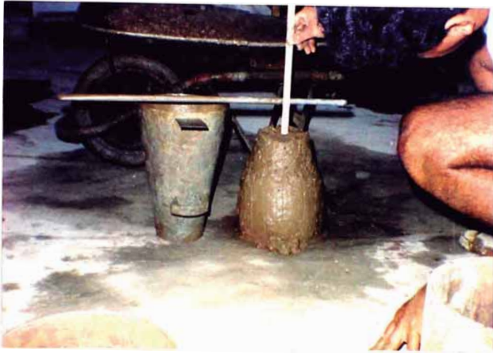
FOTO N° 15 Medición del asentamiento.
