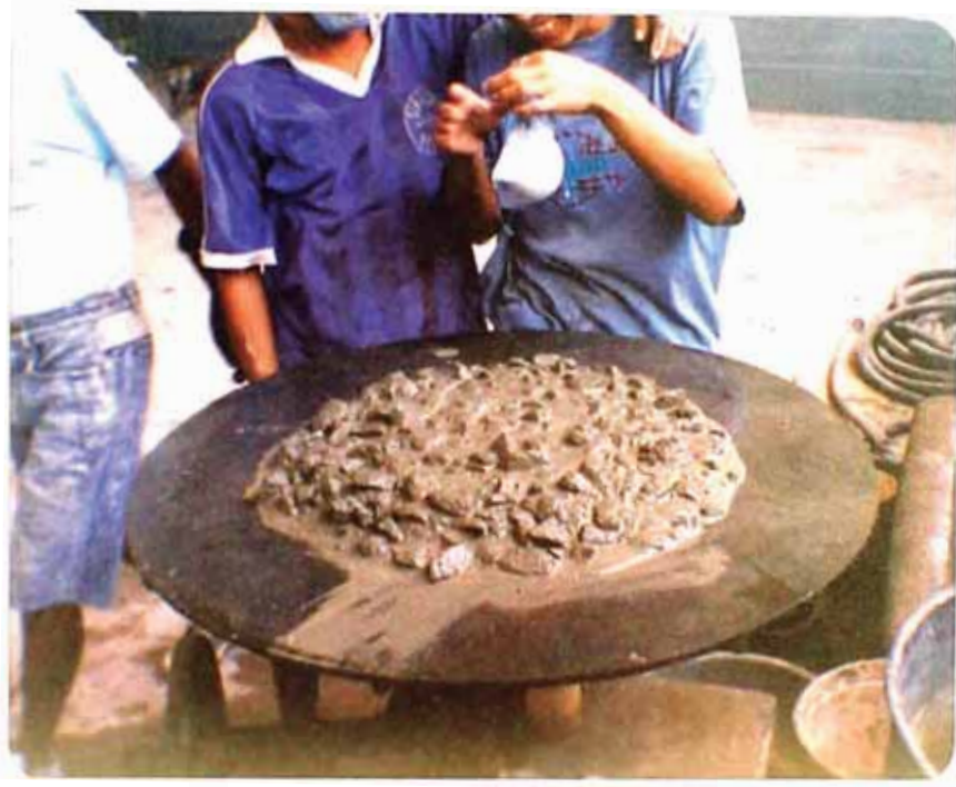
FOTO N° 16 Ensayo de fluidez (mesa de sacudidas).
