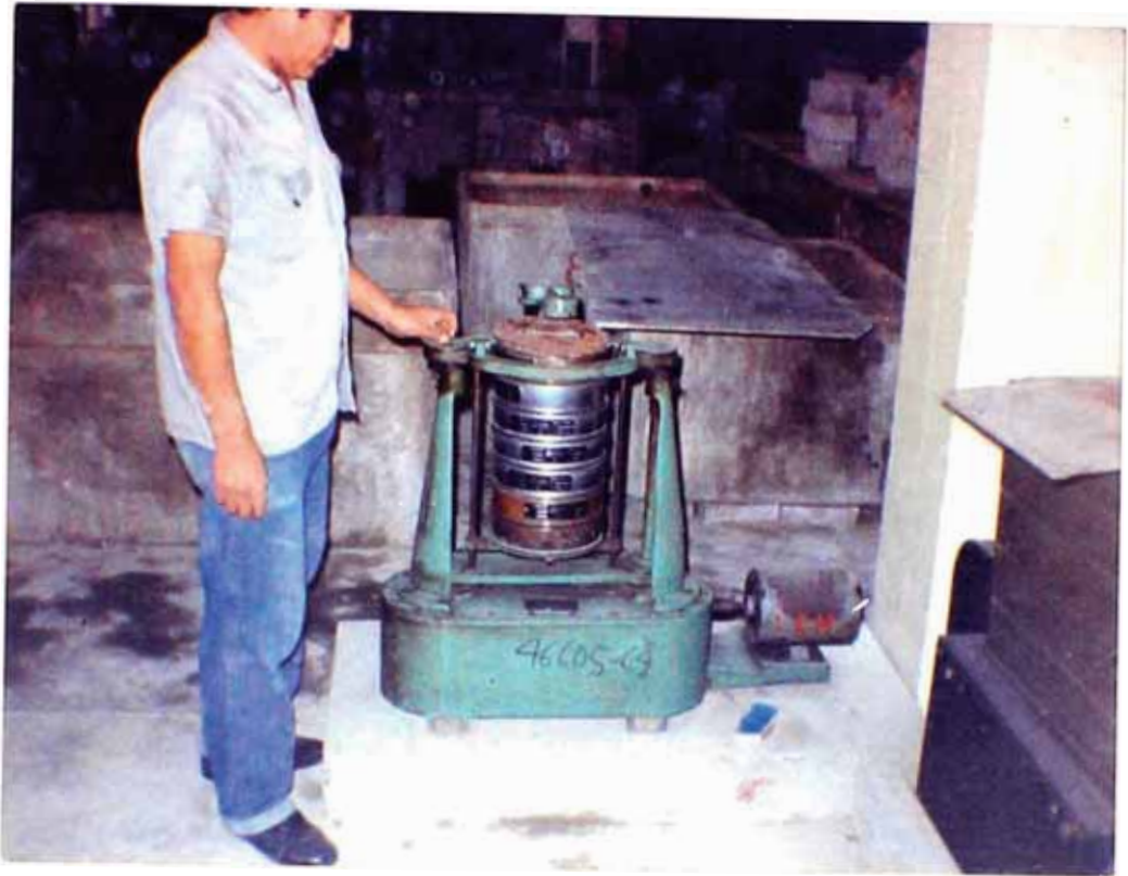
FOTO N° 7 Máquina para zarandear arena (agregado fino).
