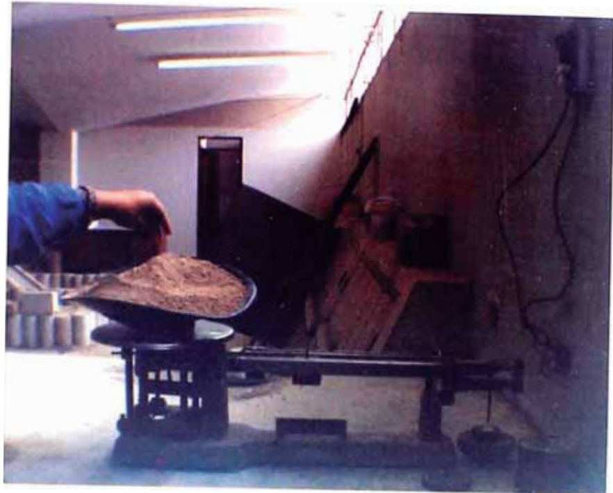
FOTO N° 5 Pesado de la arena utilizando la balanza mecánica usada en los ensayos.
