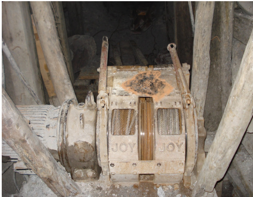
Lámina 2: Winche de arrastre dentro del tajeo - CRVCS
