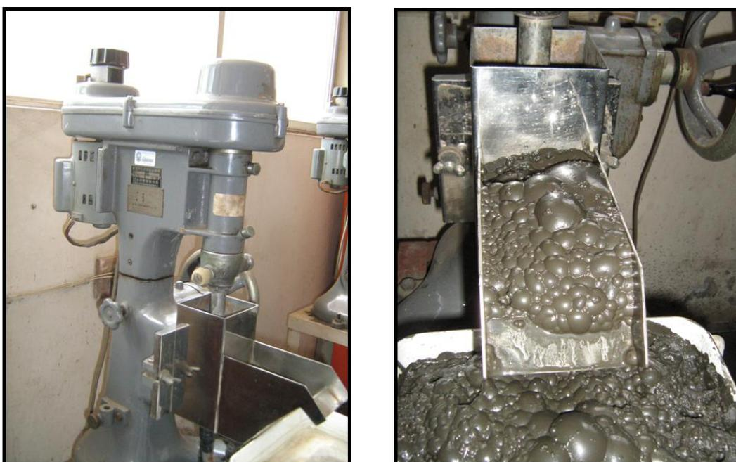
Figura 7: Formación de burbujas en celda de flotación
