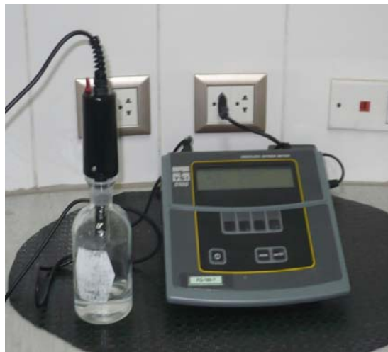
FOTO N° 5.3: METODO DEL ELECTRODO DE MEMBRANA PARA DETERMINAR OXÍGENO DISUELTO
