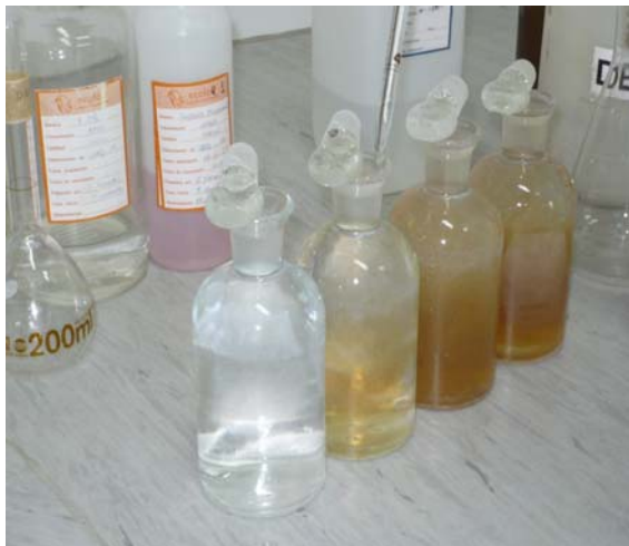
FOTO Nº5.2: METODO VOLUMETRICO PARA DETERMINAR OXÍGENO DISUELTO
