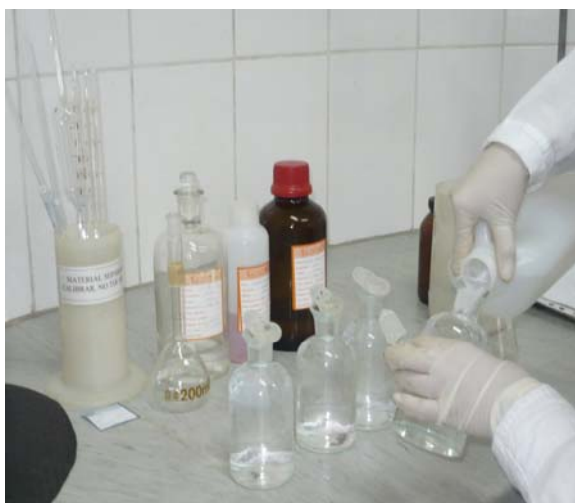
FOTO N° 5.3: METODO DEL ELECTRODO DE MEMBRANA PARA DETERMINAR OXÍGENO DISUELTO
