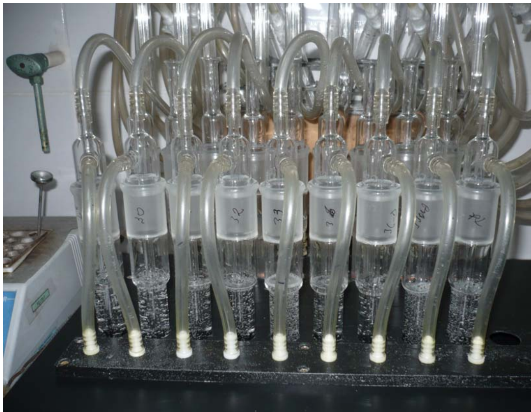
FOTO N°5.1 : EQUIPO DE DESTILACIÓN DE CIANURO TOTAL QUE SE ESTA IMPLEMENTANDO EN EL LABORATORIO DE MARCA MIDIVAP 3000.
