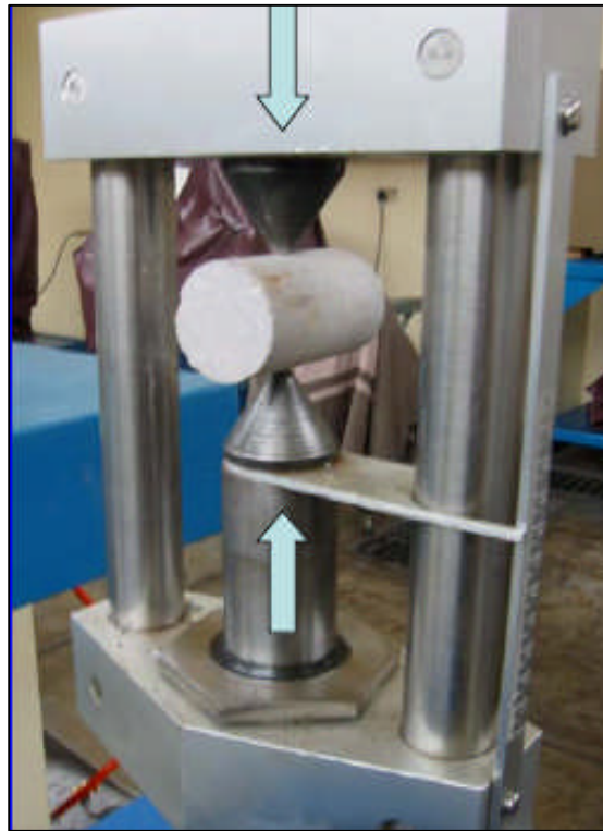
Figura 28. Equipo: máquina de ensayo de carga puntual
