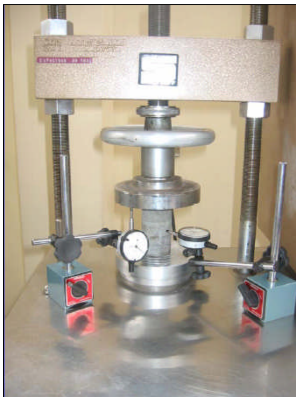
Figura 25. Equipo: prensa hidráulica y deformómetro
