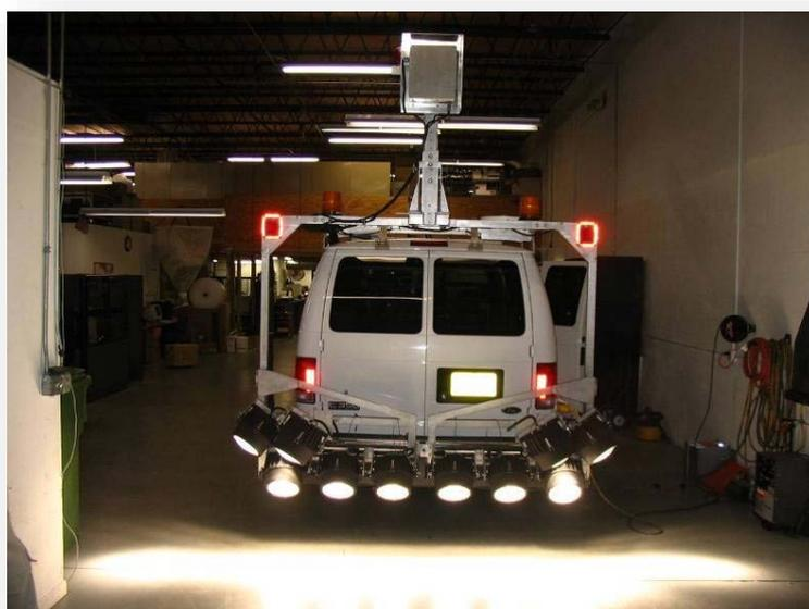
**Fotografía 2.03** Vista posterior de la camioneta que muestra el sistema de iluminación y cámaras para obtener imágenes de superficie del pavimento.
