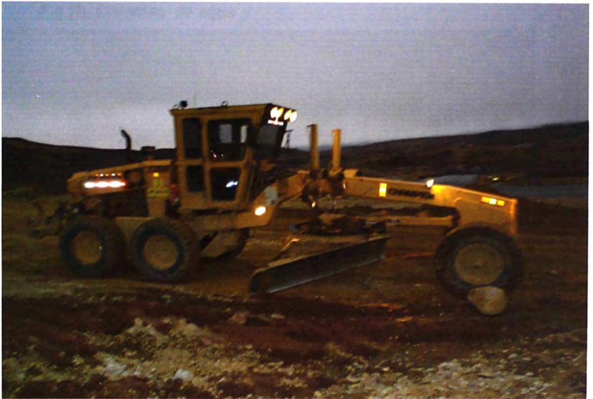
**Fig.19 Moto niveladora Komatsu**
