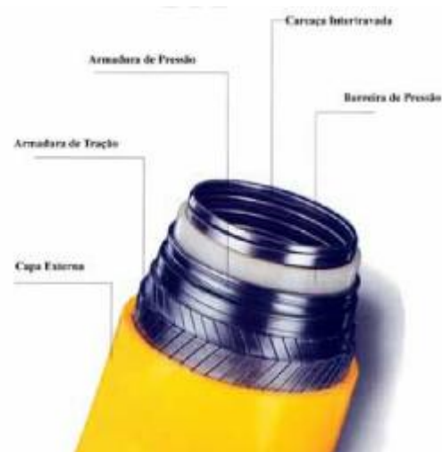
Figura 2.12 Sección típica de un riser flexible
