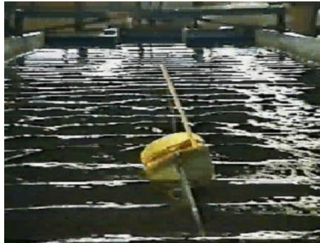
Figura 1.5 Zozobra de un pesquero por resonancia paramétrica.
