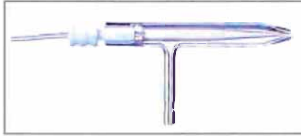
Figura 09: Generación de aerosol en un nebulizador Concéntrico
