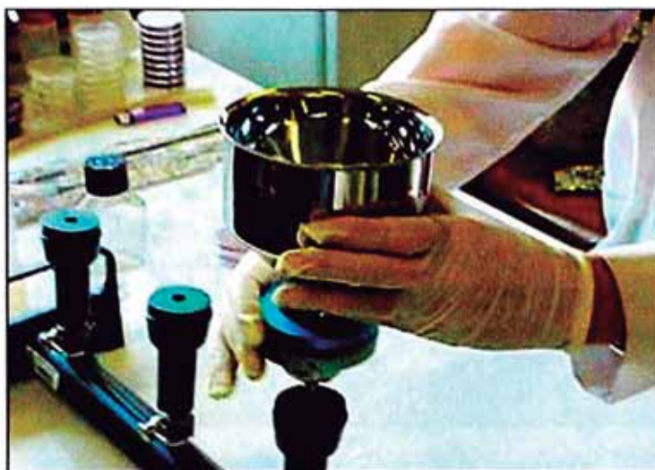
Figura N°21: Colocación del embudo
