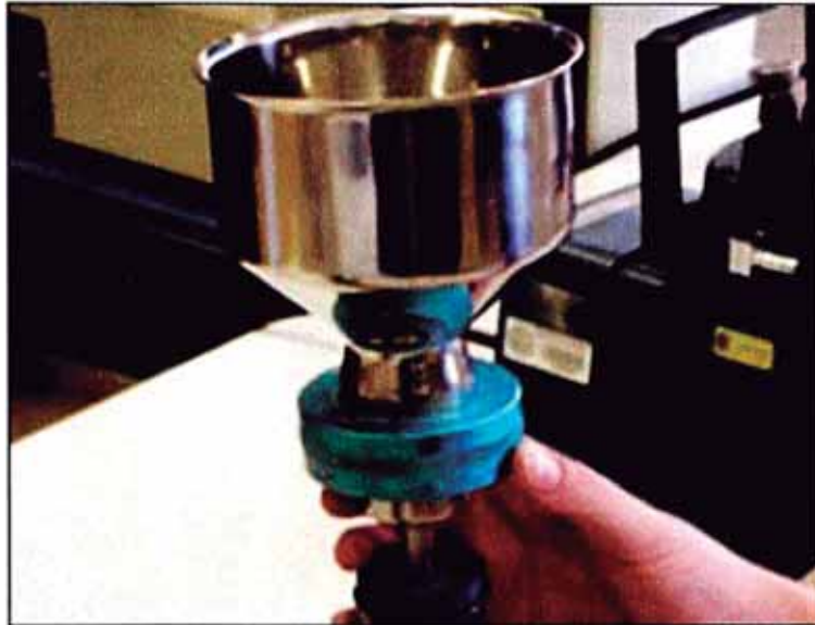
Figura N°19: Equipo utilizado para el método de Membrana Filtrante
