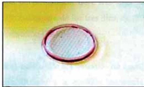
Figura N°24: Colocación de la membrana en la placa
