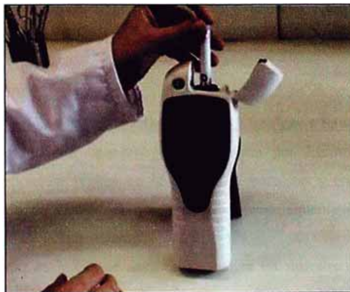
Figura N°13: Colocación del hisopo en el Luminómetro
