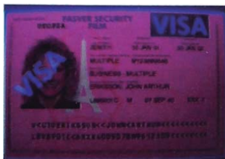
Figura II.8 Sujeto a una longitud de onda de 365nm Fuente: Estudio de investigación de la Institución
