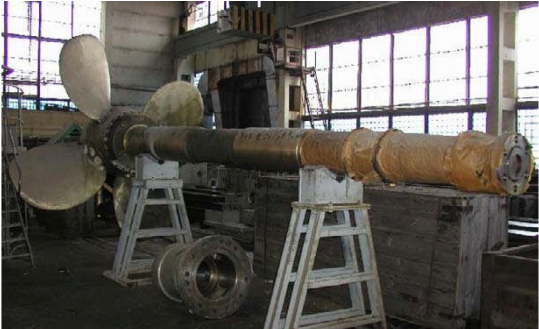
Figura Nº 4. Se muestra la camisa de bronce colocada en el eje.
