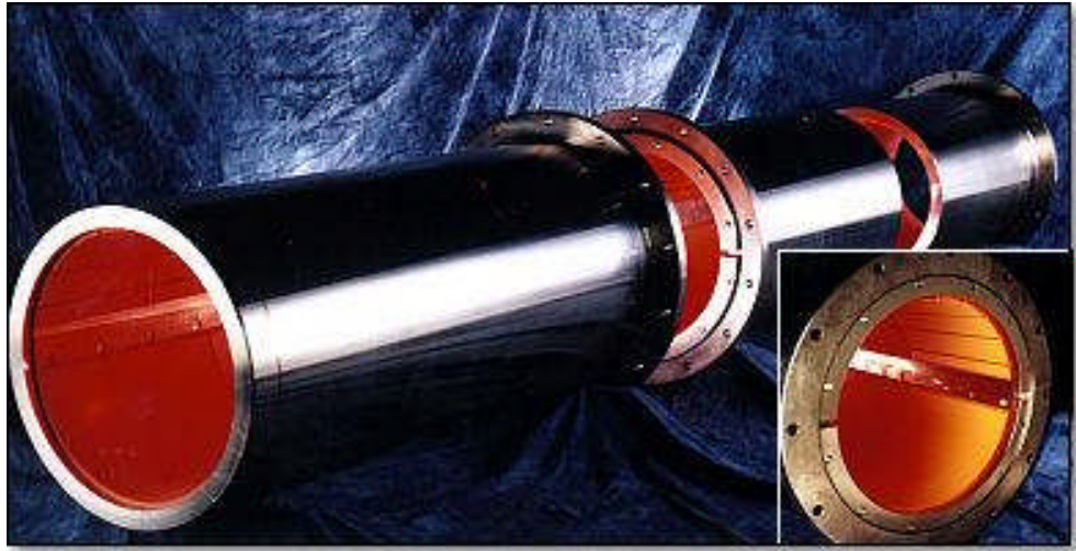
Figura N° 2.5. Se muestra la bocina de un tubo codaste.
