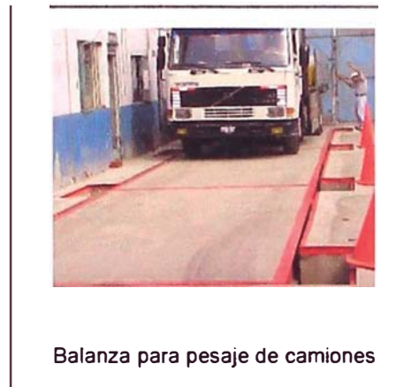
Fig.7 Celda de Carga Tipo Canister y su aplicación
