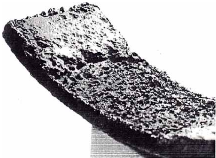
Figura N° 7: Muestra de corrosión por \text{CO}_2
