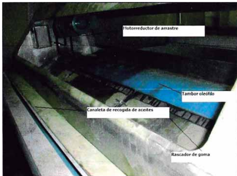
Figura 3.19: Componentes de un Skimmer de Tambor
