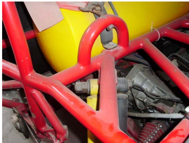
Figura 2.2- El chasis tubular como refuerzo del vehículo.
