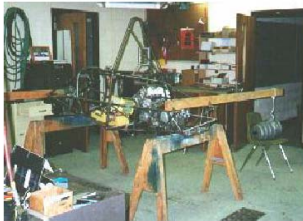
Figura 3.9- Experimento 2 para medir la rigidez torsional
