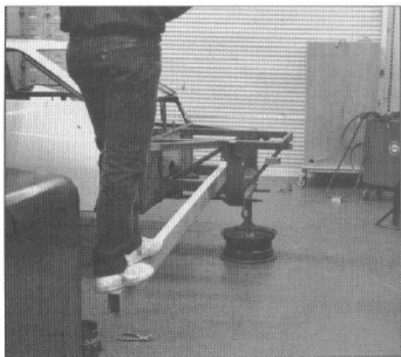
Figura 3.10: Experimento 2 para medir la rigidez torsional
