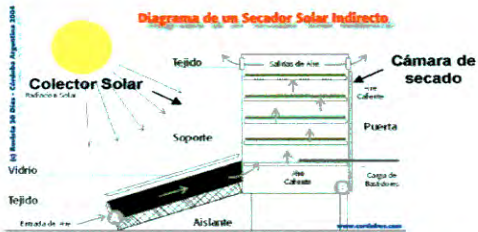
Figura 3.3.- Esquema de un secado de tipo indirecto
