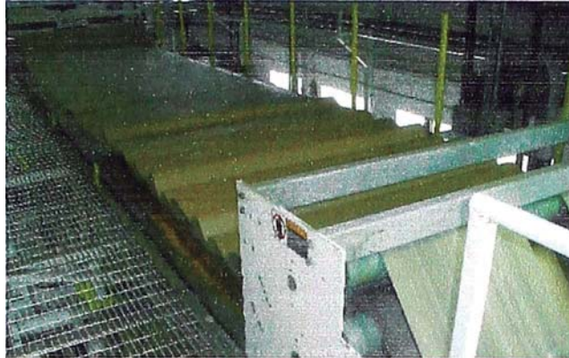
Figura N°7. Puente de la Máquina corrugadora
