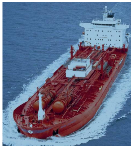
Figura 2.1. Tanque de almacenamiento de productos químicos en cargueros, construidos con aceros inoxidables dúplex [15].
