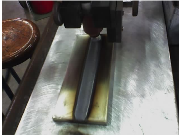
Figura 6.8. Enfriamiento después de terminado el proceso de soldeo
