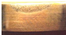
Figura 7.1. Forma, ancho y profundidad del cordón, de las muestras soldadas
