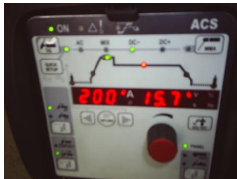
Figura 6.6. Fijación de parámetros en la máquina de soldar
