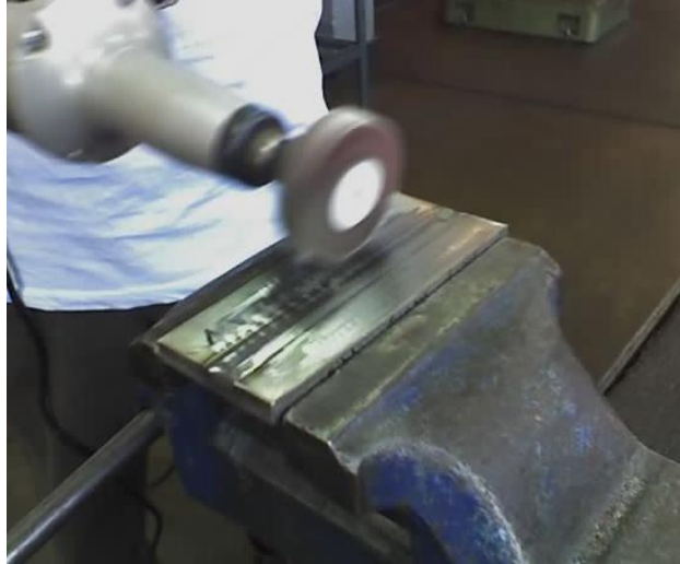
Figura 6.9. Desbaste de las planchas soldadas con esmeril.
