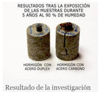
Figura 2.2 Concreto reforzado con barra corrugada de acero inoxidable dúplex izquierda y barra corrugada de acero al carbono [21].
