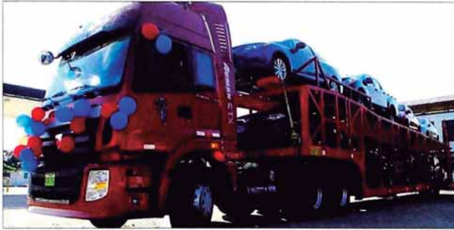
Figura N° 12 Camión cigüeña de capacidad para 9 unidades
