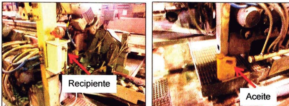
Fig.6.3 Se acondiciono un recipiente para el llenado de aceite a la máquina de pulido bilateral Titan I, que sea de fácil acceso al operario.
