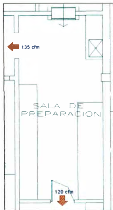
FIG 56: BALANCE DE CAUDALES – SALA DE PREPARACIÓN MICROBIOLOGIA
