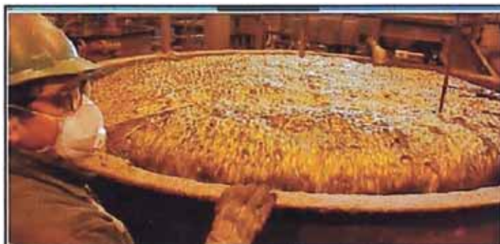
Celda columna de flotación
