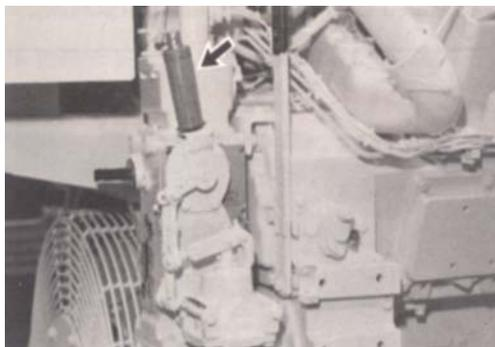
11. Mueva manualmente el **Gobernador LINKAGE**. Para regular (interrumpir) la velocidad del motor.
