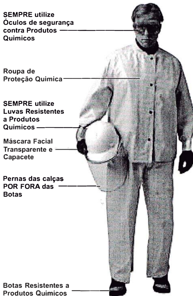
Figura 1 Roupas e Equipamentos de Proteção para o Manuseio de Soluções de Soda Cáustica a Granel
