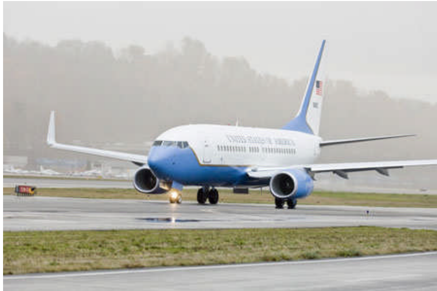
Figura N° 2-14 Boeing C-40C de la Fuerza Aérea de los EE.UU. con wingtips en las alas.
