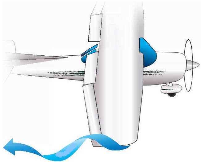
Figura N° 2-13 Representación esquemática de los vórtices de ala generados por la diferencia de presiones en el extrados y el intrados, que producirán la resistencia o arrastre inducido del ala.
