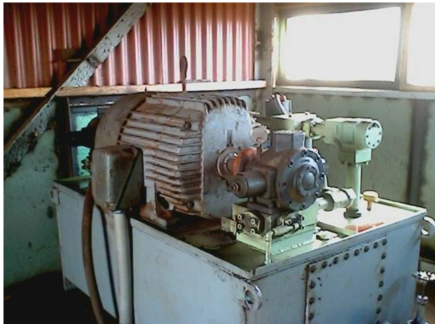
Figura 3.6 Sistema hidráulico con bomba de paletas
