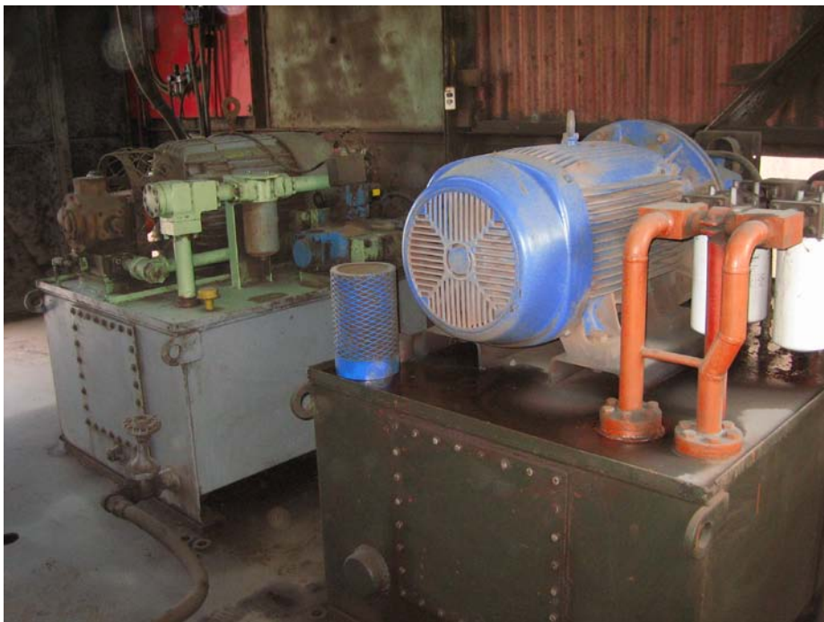
Figura 3.8 Sistema hidráulico con bomba de pistones
