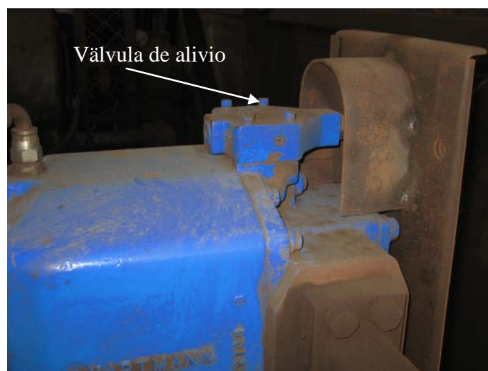
Figura 3.14 Válvula de alivio de la bomba
