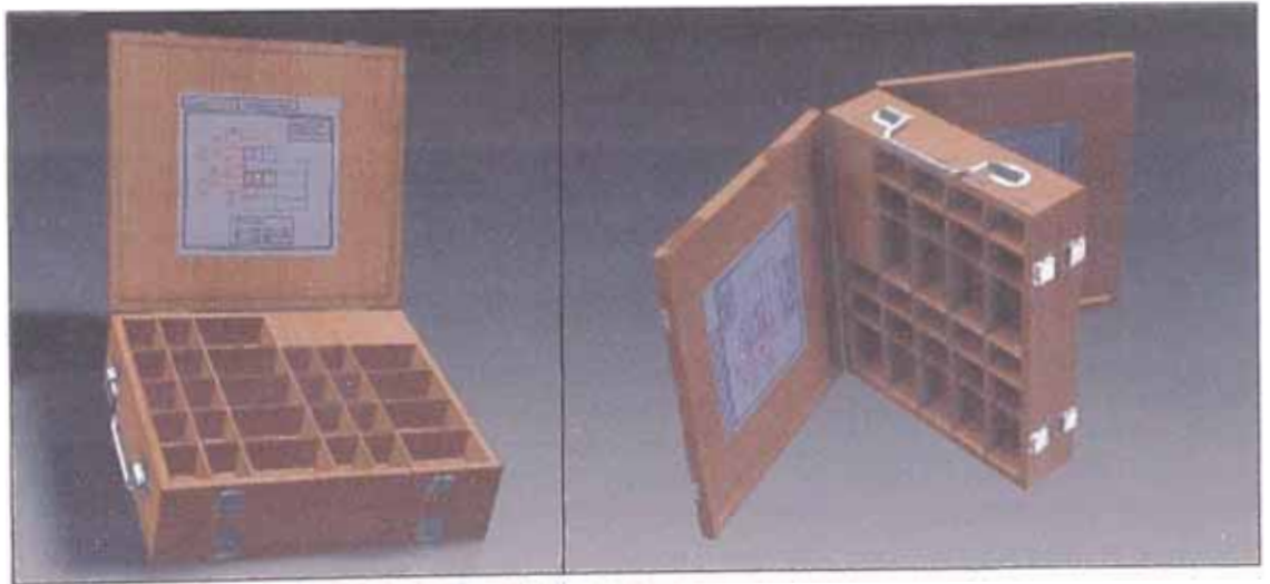
FIGURA 37: Poka Yoke para el retiro de tapones de silicona
