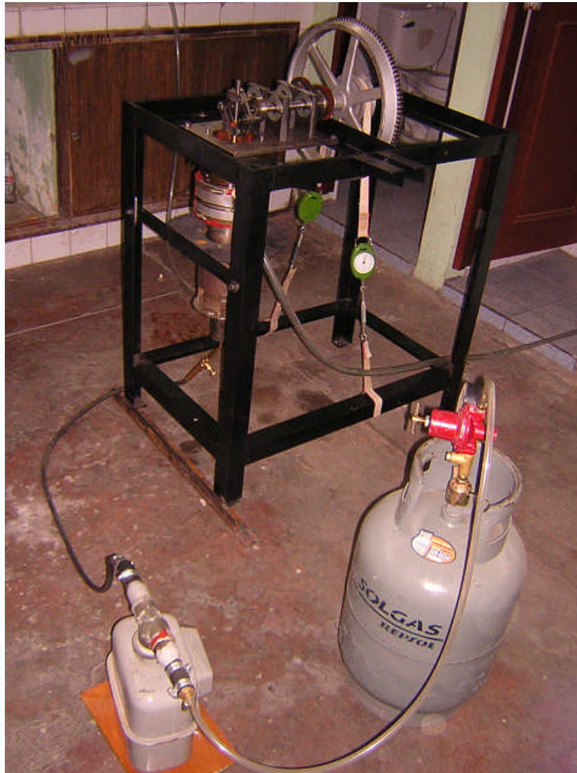
Figura 6.1 Fotografía del banco de pruebas del motor Stirling.
