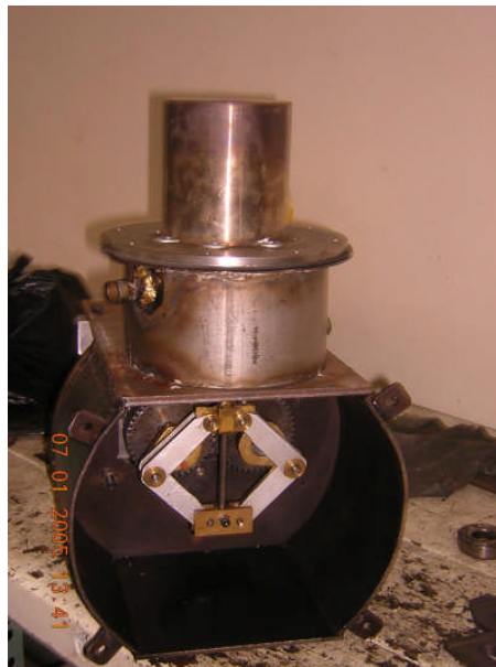
Figura 5.3 Fotografía del diseño inicial del motor Stirling con mecanismo rómbico.
