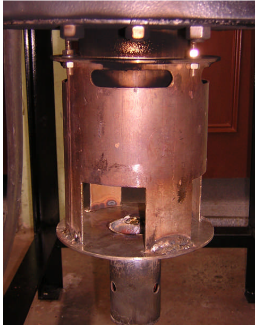
Figura 5.20 Fotografía del quemador con la cámara de combustión.
