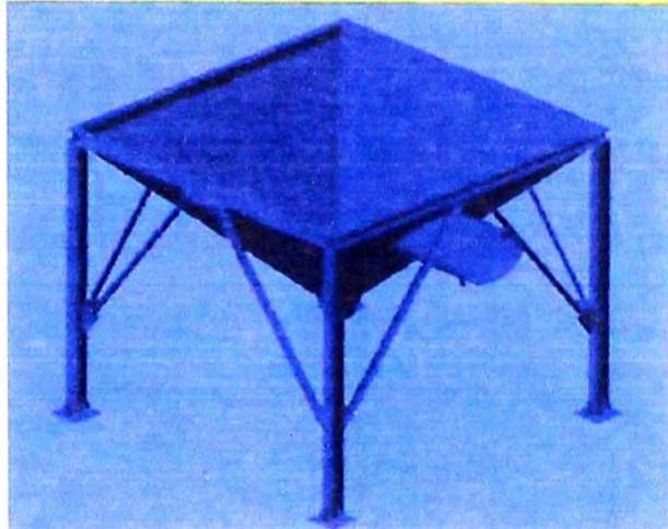
Fig. 2.17: Tolva y Estructura de Soporte.
