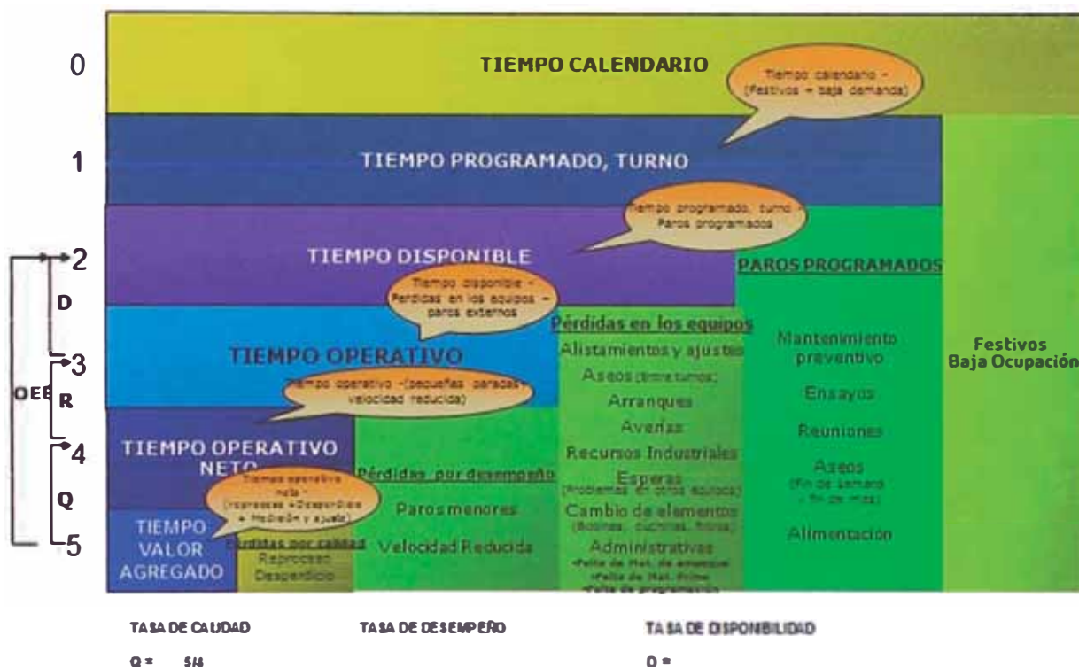
Figura 2.9 – Esquema para cálculo del OEE Fuente: Pilar de Mejora Enfocada de la empresa en estudio
