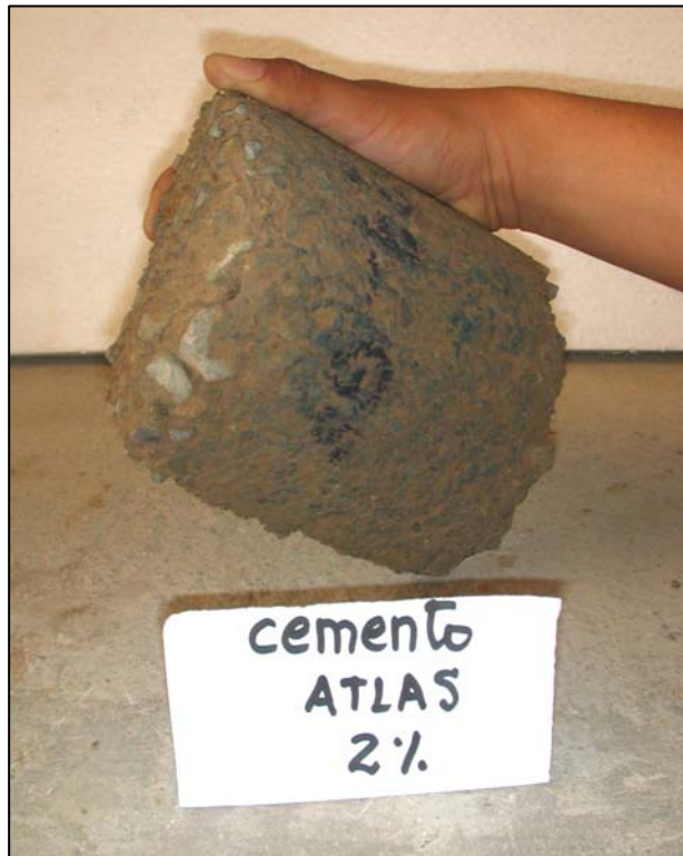
Foto N° 38 : Vista del espécimen elaborado con 2% de cemento puzolánico Tipo IP (Atlas). Este espécimen es el que mostró mayores pérdidas.
