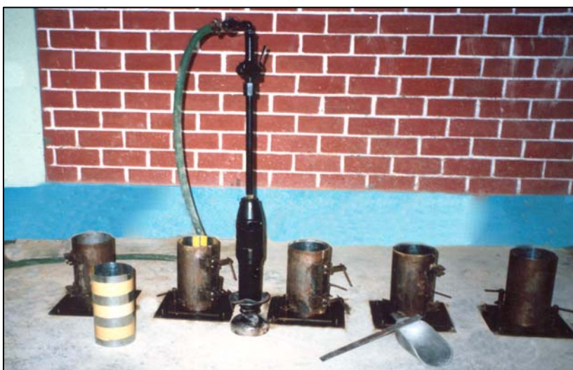
Figura Nº 3.6 Martillo neumático, moldes metálicos y fundas utilizadas en la elaboración de probetas CCR
