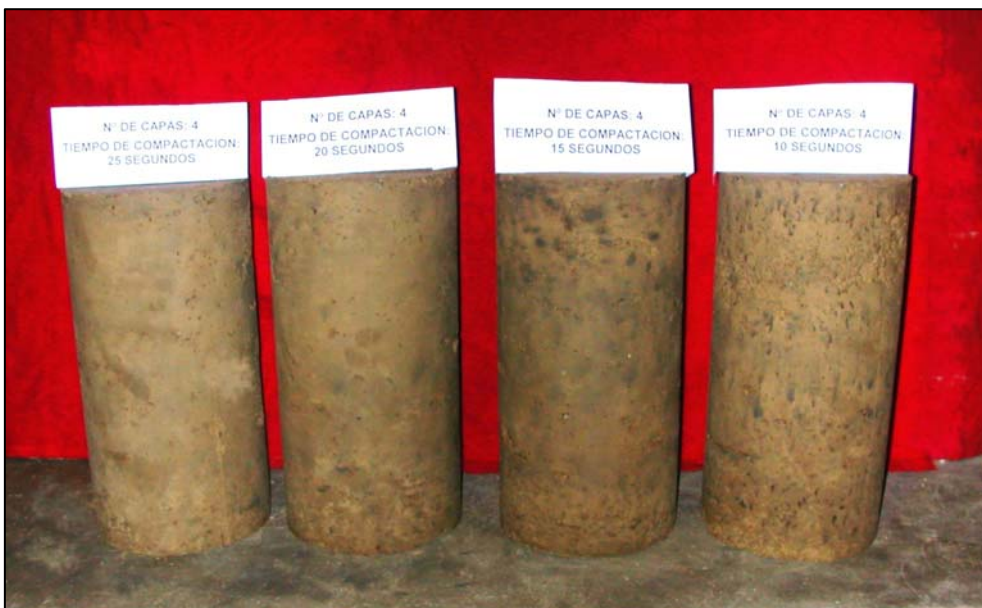
Foto Nº 6 : Probetas elaboradas mediante la compactación del CCR con un martillo Hilti en 4 capas, utilizándose los tiempos de compactación de 10, 15, 20 y 25 segundos para cada una de las capas. Las probetas se realizaron para la obtención de su densidad, proporcionarle un puntaje de apariencia y determinar el porcentaje del material averiado después del proceso de compactación.
