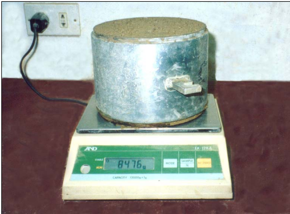
FOTO N° 3 : Obtención del peso del molde con la mezcla compactada, después de haber sido enrasado.
