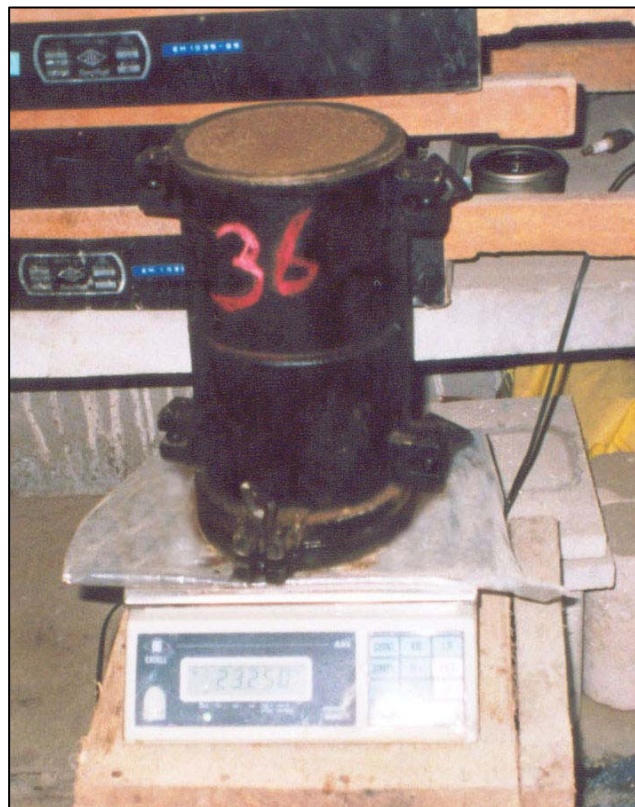
Foto Nº 12 : Una vez terminadas de elaborar las probetas se pesaron. Este peso y el volumen interior del molde metálico sirvieron para el cálculo del peso unitario de cada una de las probetas.
