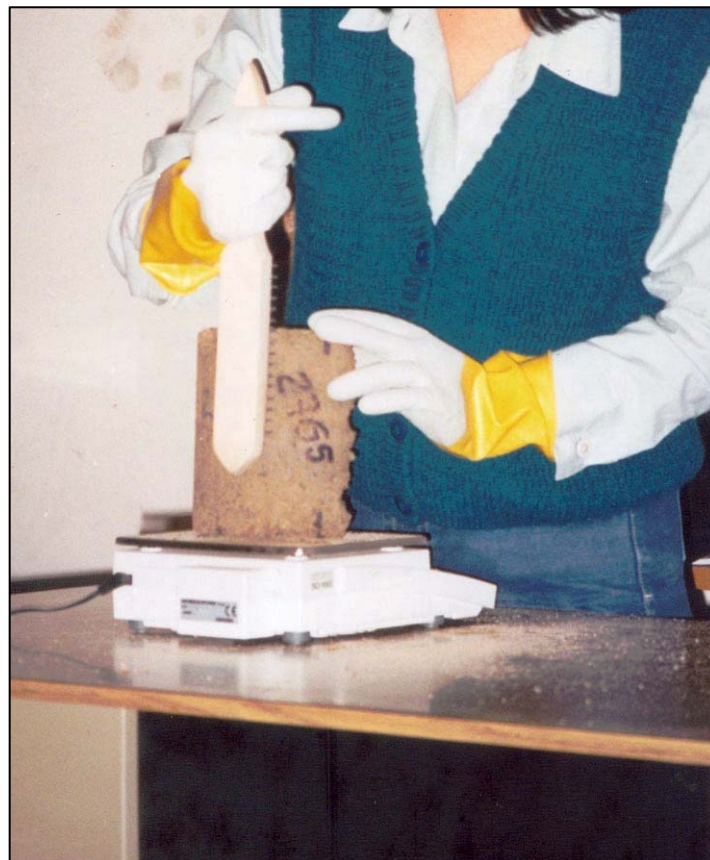
Foto Nº 34 : . El escobillado se realizó en algunas oportunidades sobre una balanza para verificar la presión aplicada.
