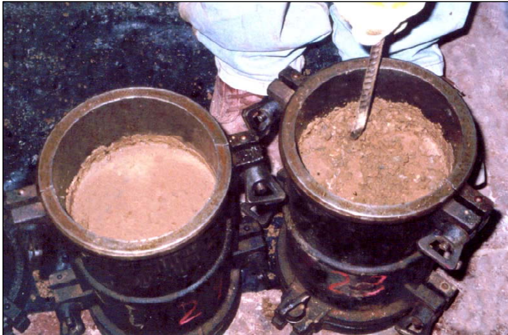
Foto Nº 11 : Escarificado realizado después de la compactación de cada una de las capas para permitir la adherencia entre ellas.
