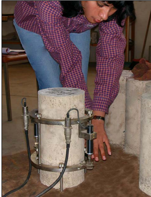
Foto N° 21 : Colocación de anillos y sensores en la probeta para medir la deformación.
