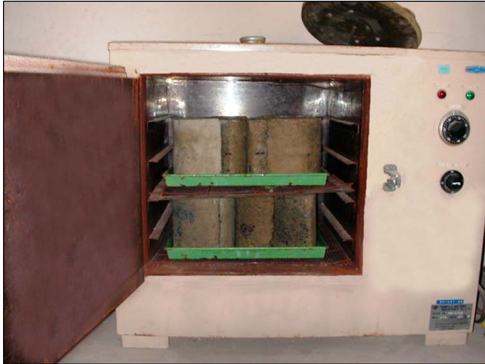
Foto N° 35 : Después de los doce ciclos de ensayo, los especímenes se secaron en el horno a 110 °C, hasta peso constante.
