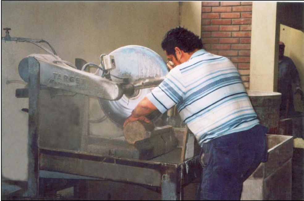
Foto N° 27 : Cortado de probeta de 7 días de edad de curado para la obtención de especímenes a utilizar en el ensayo de congelamiento/deshielo. Se fabricaron dos especímenes por cada tipo de mezcla investigada.
