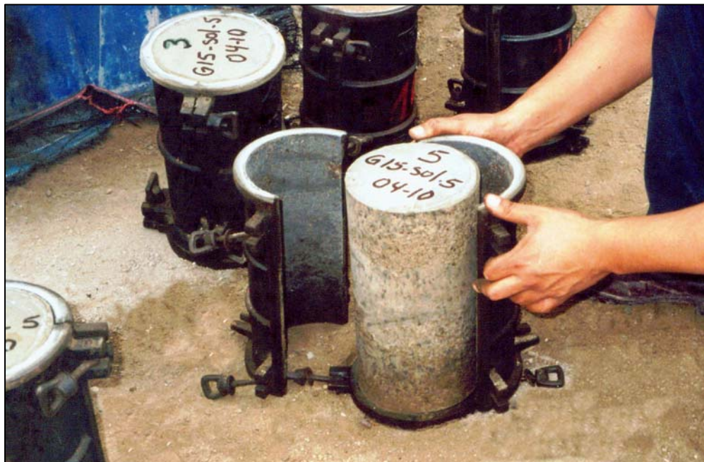
Foto N° 14: Desmolde de probetas CCR. Se observan los moldes partidos que se utilizaron para permitir el fácil desmoldaje.
