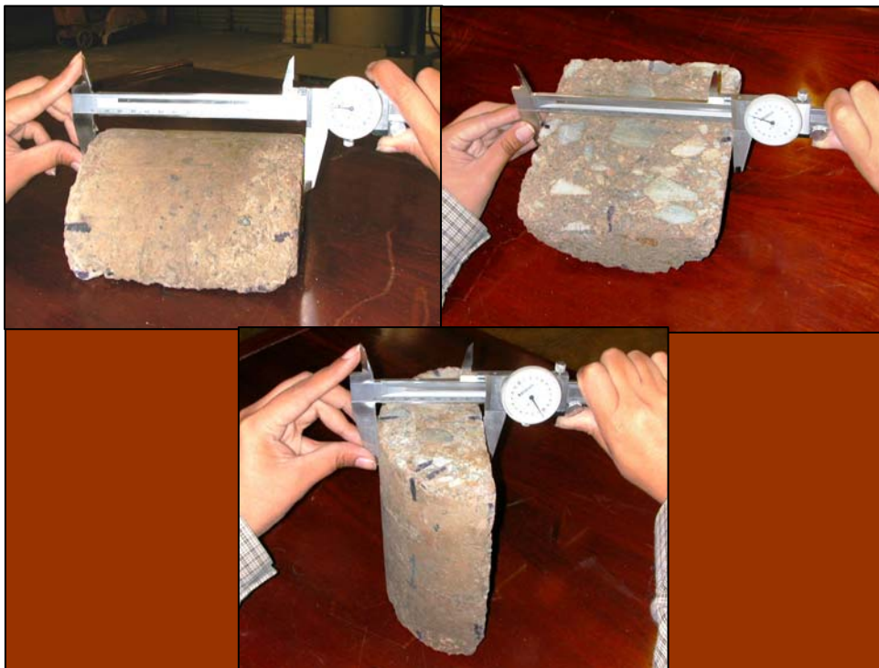
Foto N° 28 : Medida de las dimensiones de los especímenes. La medición se realizó al inicio del ensayo y cada vez que se retiraban de la congeladora y de la cámara húmeda
