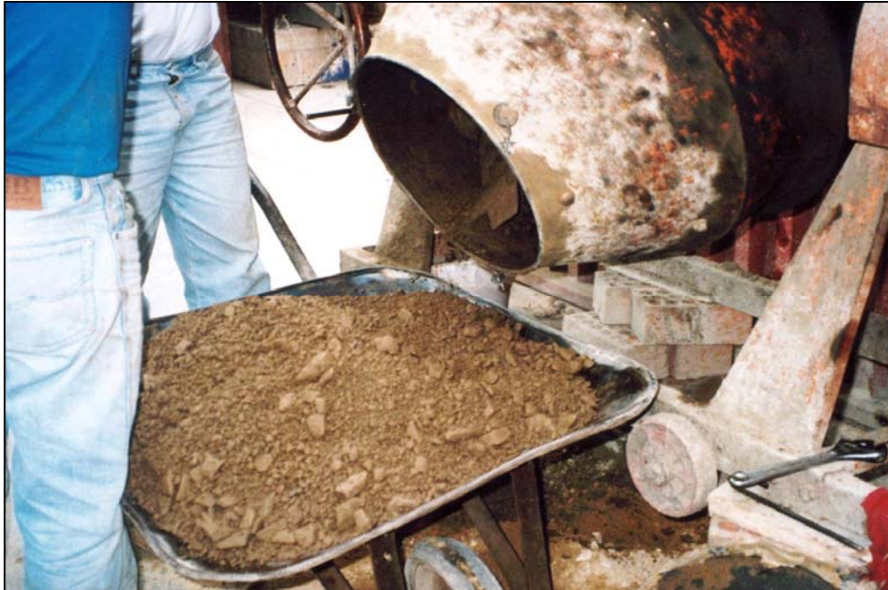
Foto N° 7 : CCR luego de ser vaciado de la mezcladora. El tamaño máximo de agregado utilizado fue de 1 ½ pulg. Se observa la consistencia seca de la mezcla.
