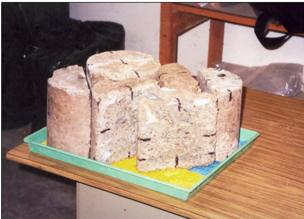
Foto N° 30 : Cada vez que los especímenes son llevados a la congeladora o a la cámara húmeda se colocaron en una bandeja y entre ellas se colocó un fieltro saturado con agua. Se observan las marcas en el lugar que se realizaron las mediciones en cada uno de los ciclos.
