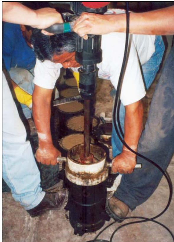
Foto N° 10 : Para la compactación de la última capa de las probetas se utilizó un collarín de extensión de 2 pulg de altura.
