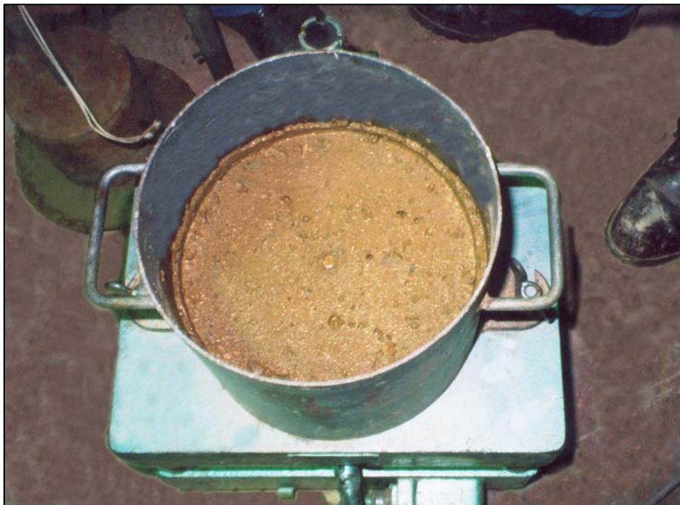
Foto Nº 20 : Mezcla CCR, después de realizado el ensayo de consistencia.
