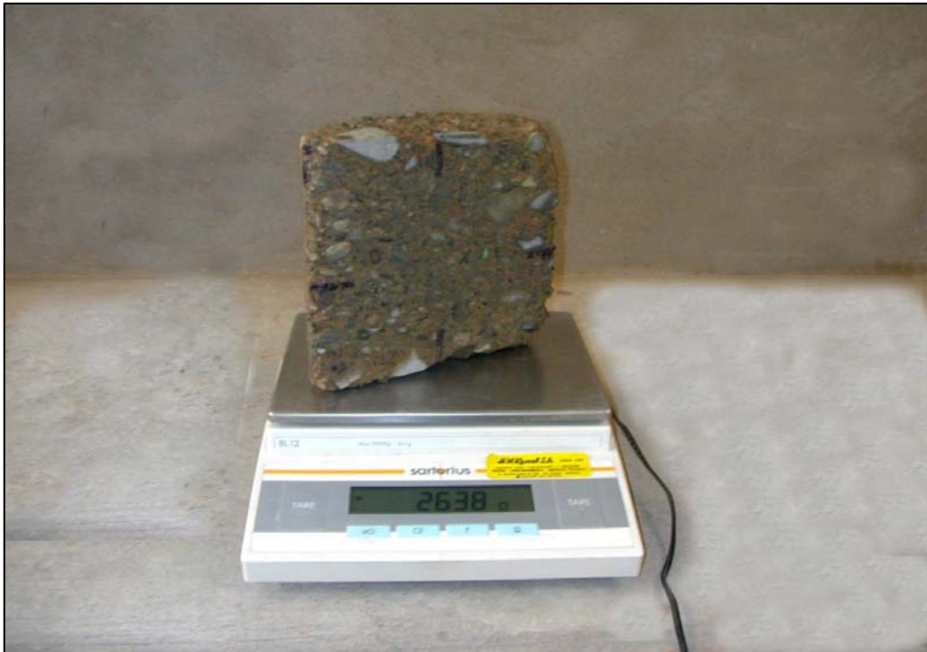
Foto N° 29 : El pesado de los especímenes se realizó al inicio del ensayo y después de retirarlos de la congeladora y de la cámara húmeda en cada uno de los ciclos para controlar la pérdida de material.
