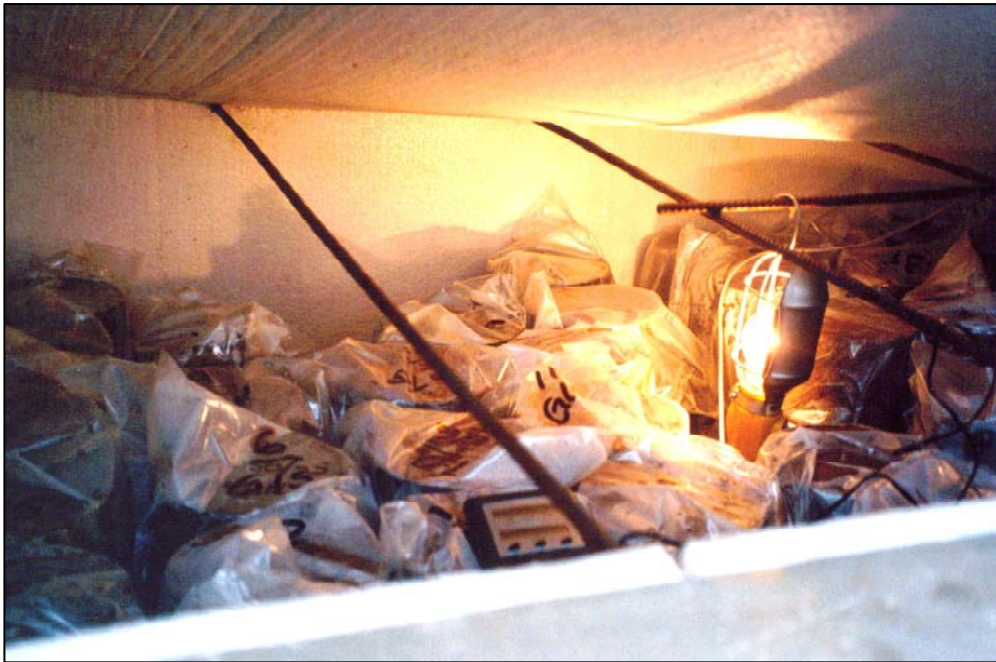
Foto N° 17 : Cámara húmeda de curado. En ocasiones se utilizaron focos para mantener la temperatura. Se observa el dispositivo utilizado para la medición de la humedad y temperatura dentro de la cámara.
