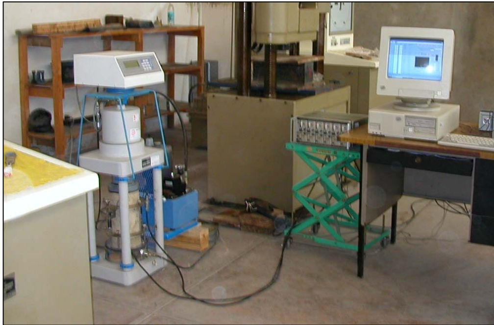
Foto Nº 25 : Vista de equipo completo utilizado en la medida de la resistencia a la compresión y módulo de elasticidad: prensa y equipo adquiridor de datos
