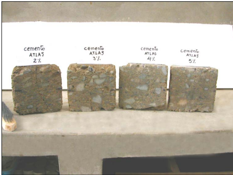
Foto N° 37 : Estado final de especímenes fabricados con cemento Pozolánico Tipo IP (Atlas), después de los 12 ciclos de congelamiento/deshielo. Obsérvese la rajadura en el espécimen con 2% de cemento.
