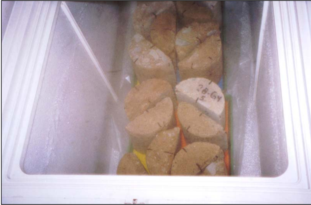
Foto N° 31 : Etapa de congelamiento. Los especímenes se colocaron en una congeladora a una temperatura constante de -23^{\circ}\text{C} por un tiempo de 24 horas en cada uno de los ciclos.
