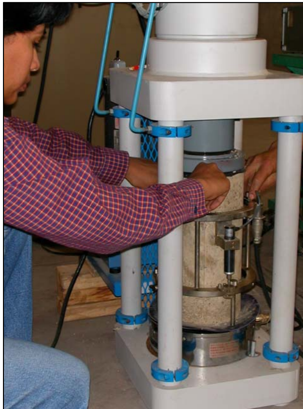
Foto N° 22 : Luego de colocar la probeta en la prensa se desajustaron los tornillos nivelantes para dar inicio a la aplicación de la carga.
