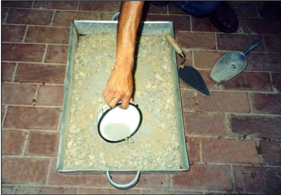
FOTO Nº 1 : Mezcla del agregado con el cemento para la realización del ensayo Proctor Modificado. El porcentaje de cemento utilizado fue con respecto al peso seco de los agregados.
