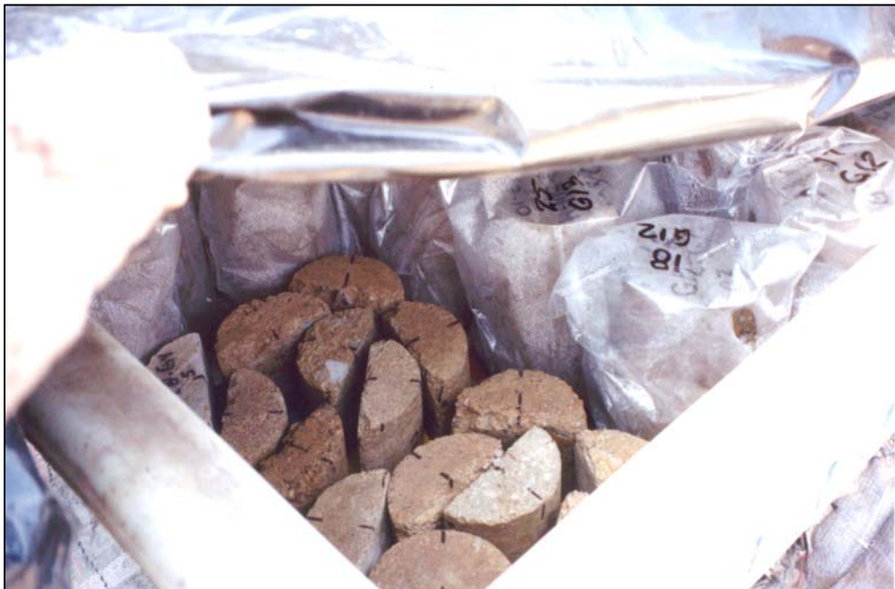
Foto N° 32 : Etapa de deshielo. Los especímenes se colocaron en la cámara húmeda por 23 horas en cada uno de los ciclos.
