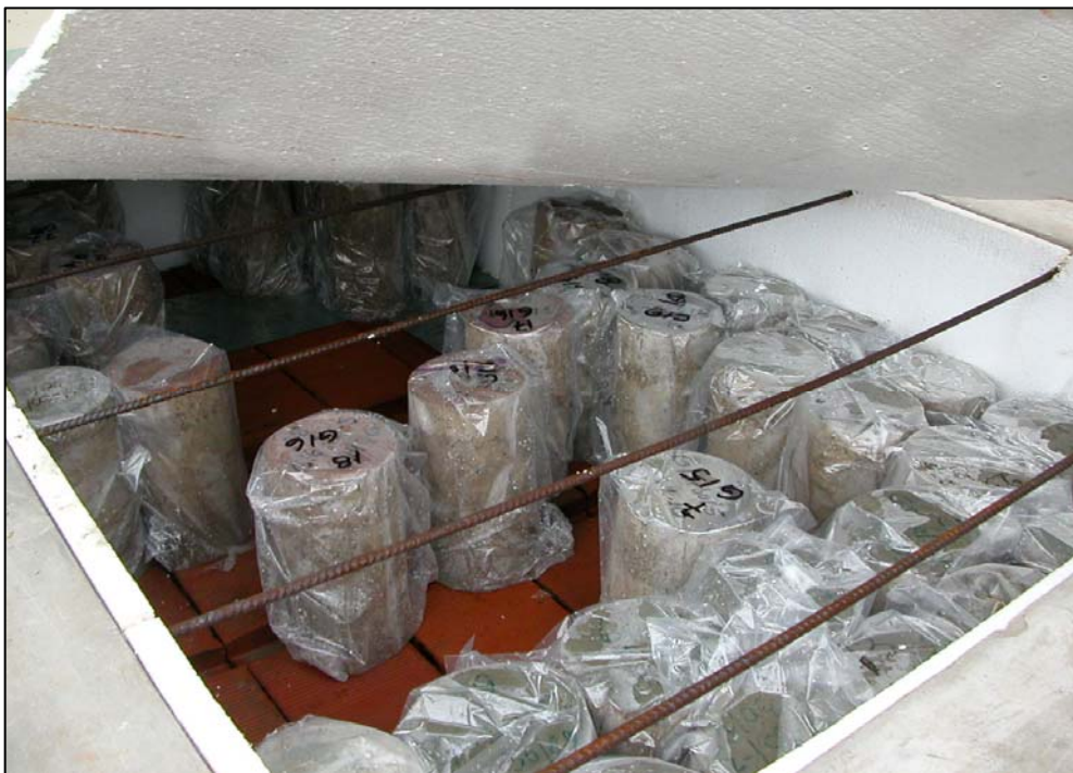
Foto N° 16 : Cámara húmeda de curado. Se adaptaron paredes de tecknoport y en el fondo se mantuvo un espejo de agua para mantener la temperatura y humedad controlada ( 23^{\circ}\text{C} \pm 2^{\circ}\text{C} y 95\% \pm 5\% ).
