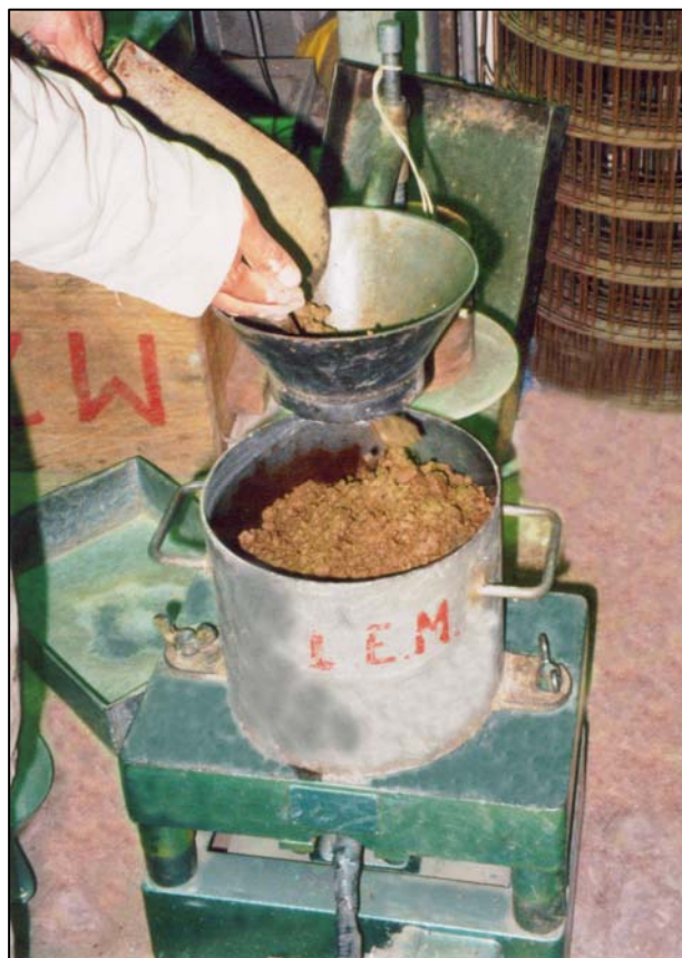
Foto N° 18 : Ensayo de consistencia VeBe realizado con cada una de las muestras CCR investigadas, según norma ASTM C 1170. Se observa el vaciado de la muestra a la olla del VeBe.
