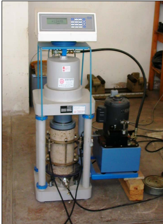
Foto N° 23 : Ensayo de resistencia a la compresión, según Norma ASTM C 39. Se observa la prensa con la probeta colocada en el momento del ensayo.
