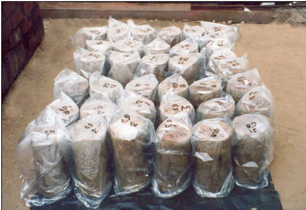
Foto N° 15 : Una vez desmoldadas las probetas, se cubrieron con bolsas plásticas para evitar la pérdida de humedad. Inmediatamente después se colocaron en la cámara húmeda.
