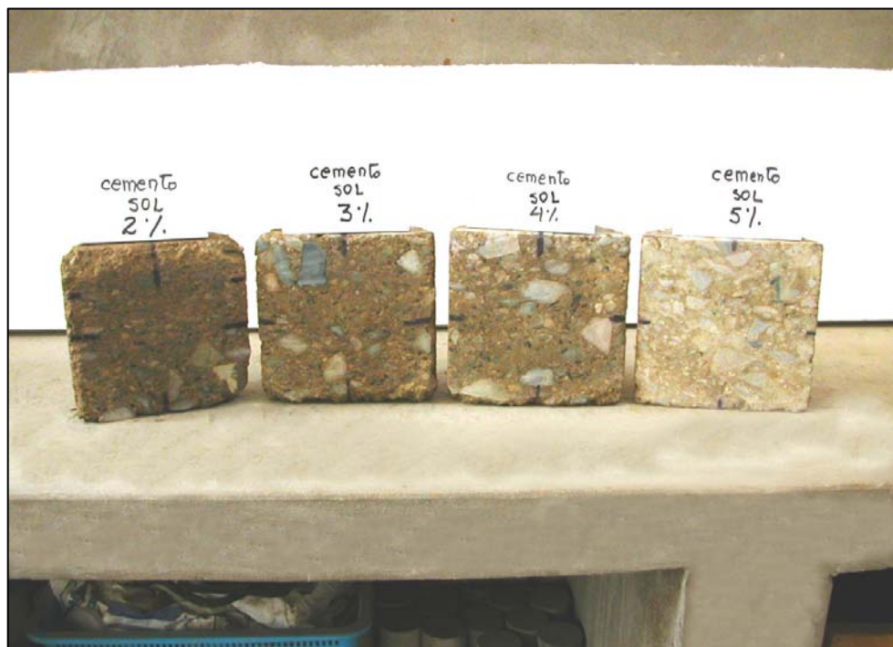
Foto N° 36 : Estado final de especímenes fabricados con cemento Pórtland Tipo I (Sol), después de los 12 ciclos de congelamiento/deshielo.
