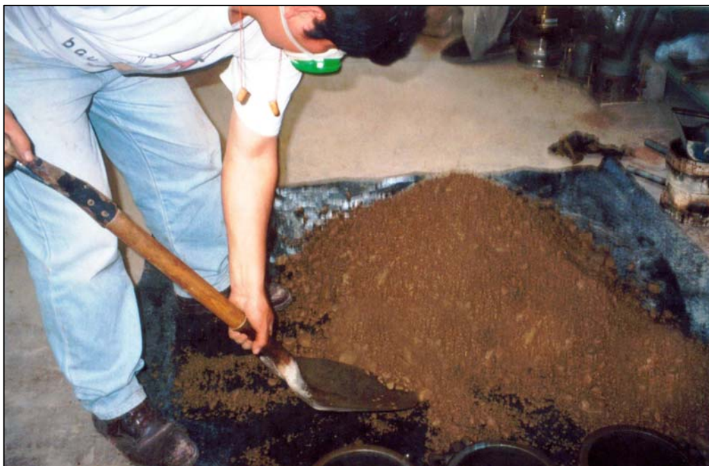
Foto N° 8 : Posteriormente el CCR es vaciado sobre una superficie impermeable y se procede a mezclar en forma manual.
