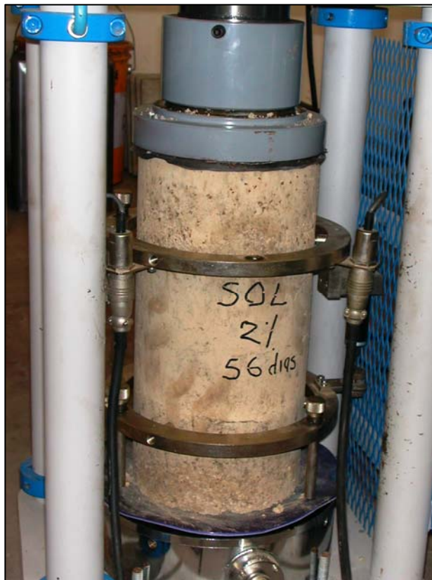
Foto N° 24 : Probeta CCR en la prensa. Se observa los dispositivos colocados para la medida de la deformación.
