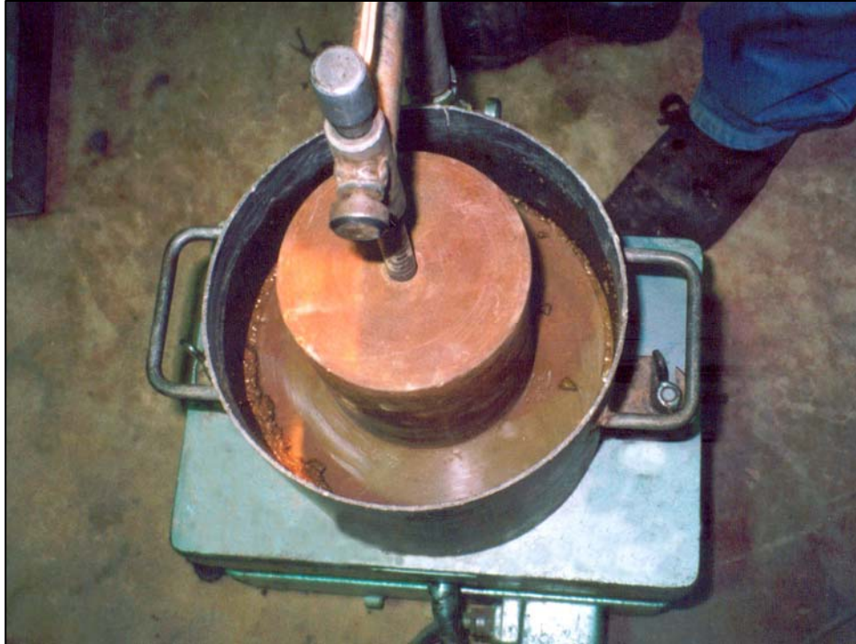
Foto Nº 19: Aplicación de la carga y vibrado de la mesa VeBe. Se observa el anillo de pasta formado en el borde interior de la olla.
