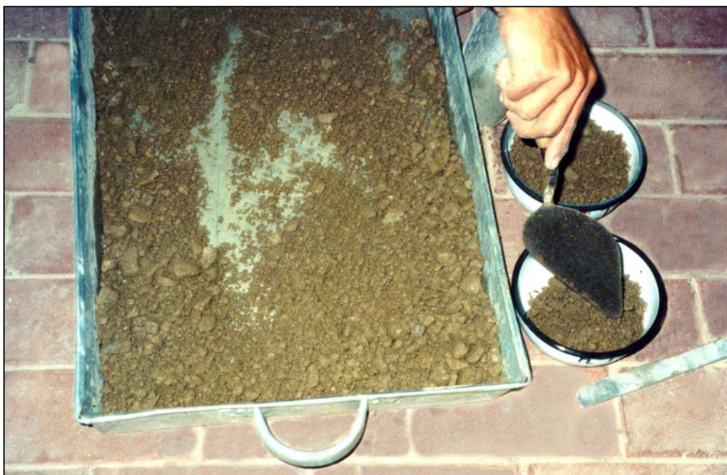
FOTO N° 4 : Toma de muestras representativas para la obtención del contenido de humedad de la mezcla utilizada en el ensayo Proctor Modificado.
