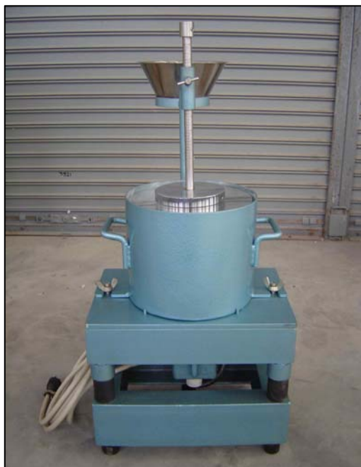
Figura N° 3.4 Aparato VeBe para medir la consistencia del CCR en mezclas con aproximación a concreto
