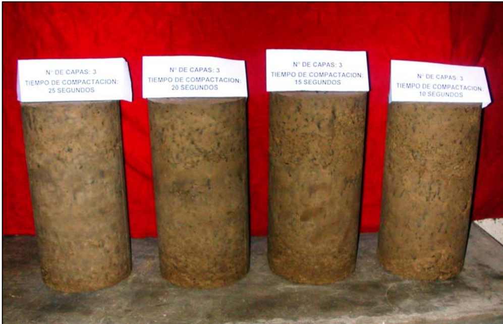
Foto Nº 5 : Probetas elaboradas mediante la compactación del CCR con un martillo Hilti en 3 capas, utilizándose los tiempos de compactación de 10, 15, 20 y 25 segundos para cada una de las capas. Las probetas se realizaron para la obtención de su densidad, proporcionarle un puntaje de apariencia y determinar el porcentaje del material averiado después del proceso de compactación.
