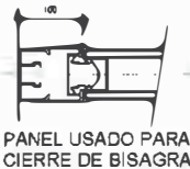
DETALLE DE PANELES OMNI DIRECCIONAL SERIE 6600-F VENTANAS LISTAS ESC. 1/10
