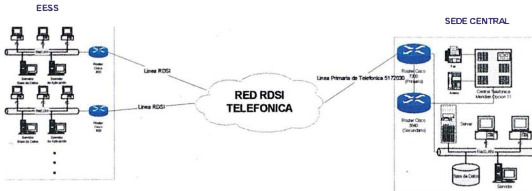
En la sede central el router CISCO 7200 posee 30 canales digitales, evitando de esta forma la posible saturación de la línea debido a un alto número de conexiones concurrentes.
