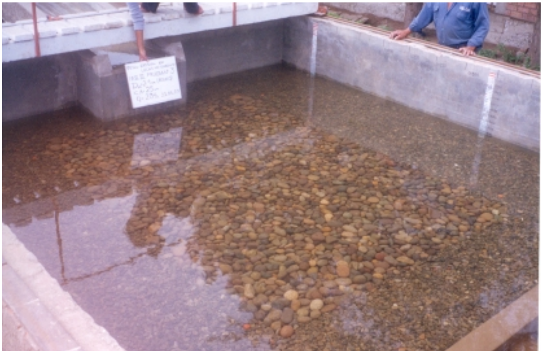
Foto N° 44: Fase III - Prueba 4 : ( Q = 0.02 \text{ m}^3/\text{s} , h_{CA} = 0.50 \text{ m} , d_{50} = 49.08 \text{ mm} ). Vista del cuenco después de dos horas de prueba. De modo similar a la prueba anterior no se produjo erosión.
