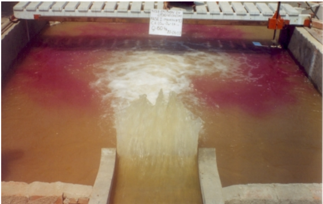
Foto N° 23: Fase I - Prueba 10. ( Q = 0.06 \text{ m}^3/\text{s} , h_{CA} = 0.10 \text{ m} , d_{50} = 1.60 \text{ mm} ) Vista de la distribución del flujo en el cuenco. Para ello se utilizó un trazador de color púrpura denominado permanganato de potasio.
