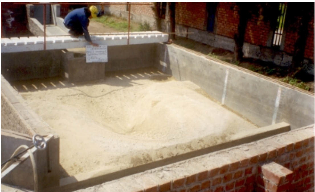
Foto N° 26: Fase I - Prueba 11. ( Q = 0.06 \text{ m}^3/\text{s} , h_{CA} = 0.25 \text{ m} , d_{50} = 1.60 \text{ mm} ) Vista del pozo de erosión después de 2 horas de prueba. La profundidad de erosión fue de 0.349 m.
