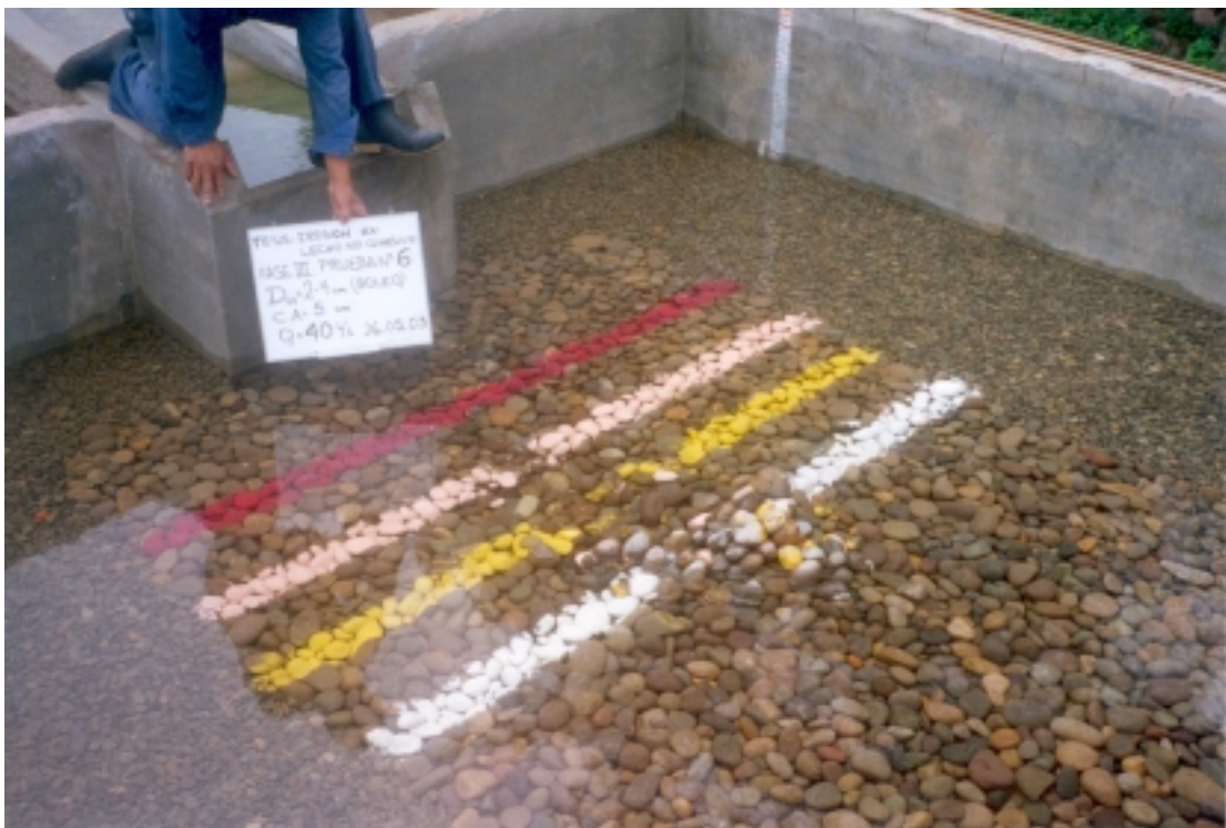
Foto N° 46: Fase III - Prueba 6: ( Q = 0.04 \text{ m}^3/\text{s} , h_{CA} = 0.05 \text{ m} , d_{50} = 49.08 \text{ mm} ). Vista de la poza de erosión después de dos horas de prueba. La profundidad de erosión fue de 0.137 \text{ m} .
