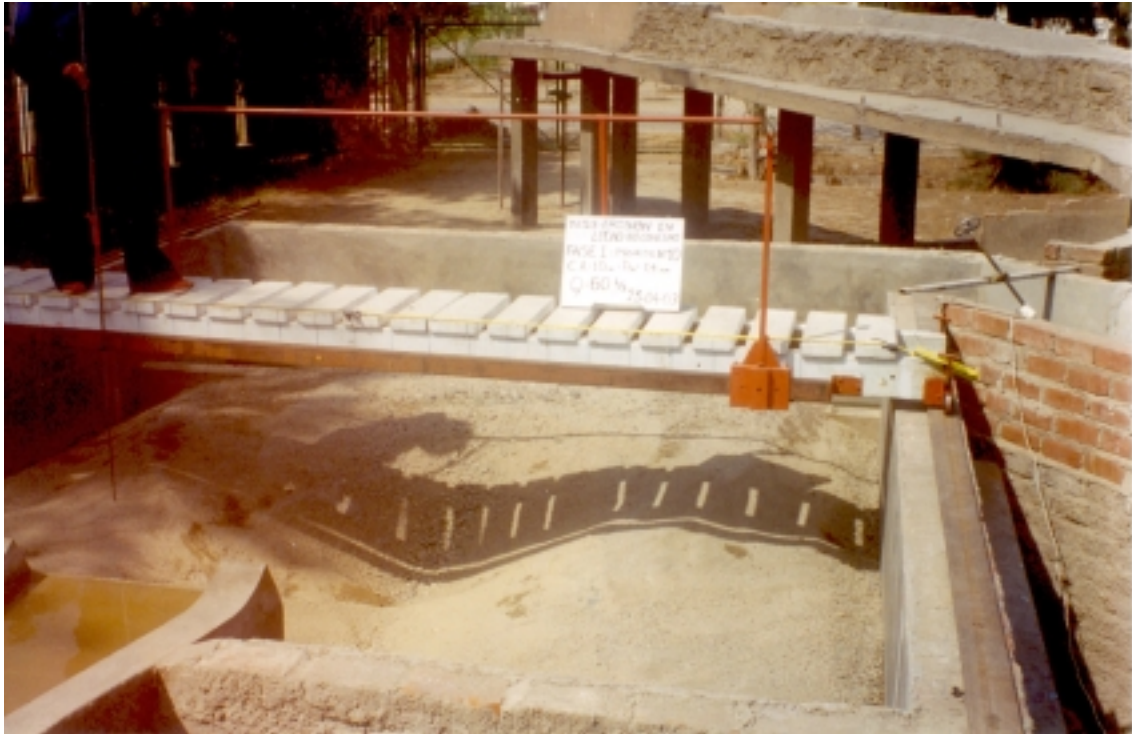
Foto N° 24: Fase I - Prueba 10. ( Q = 0.06 \text{ m}^3/\text{s} , h_{CA} = 0.10 \text{ m} , d_{50} = 1,60 \text{ mm} ) Vista del levantamiento topográfico del pozo de erosión. La profundidad de este fue de 0.410 m.
