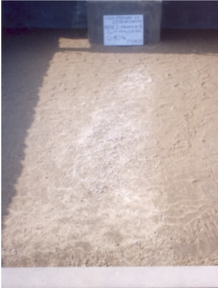
Foto N° 20: Fase I - Prueba 8. ( Q = 0.04 \text{ m}^3/\text{s} , h_{CA} = 0.50 \text{ m} , d_{50} = 1.60 \text{ mm} ) La superficie del suelo no ha sido erosionada, solo se observa una leve mancha en la cual aparecen levemente os materiales gruesos, al parecer los finos fueron lavados.
