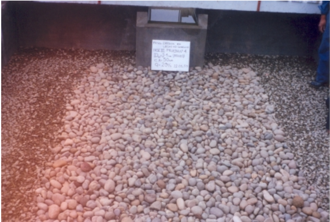
Foto N° 43: Fase III - Prueba 3 : ( Q = 0.02 \text{ m}^3/\text{s} , h_{CA} = 0.25 \text{ m} , d_{50} = 49.08 \text{ mm} ). Vista del cuenco después de dos horas de prueba. No se produjo erosión.
