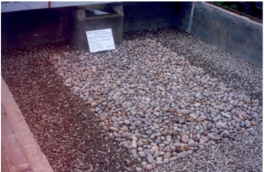
Foto N° 42: Fase III - Prueba 2: ( Q = 0.02 \text{ m}^3/\text{s} , h_{CA} = 0.10 \text{ m} , d_{50} = 49.08 \text{ mm} ). Vista de la poza de erosión después de dos horas de prueba. La profundidad de erosión fue de 0.058 m.
