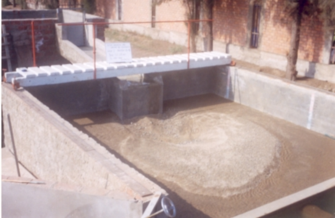
Foto N° 14: Fase I - Prueba 4. ( Q = 0.02 \text{ m}^3/\text{s} ; h_{CA} 0.05 \text{ m} ; d_{50} = 1.60 \text{ mm} ) Se observa la poza de erosión después de dos horas de prueba. La profundidad fue de 0.183 \text{ m}
