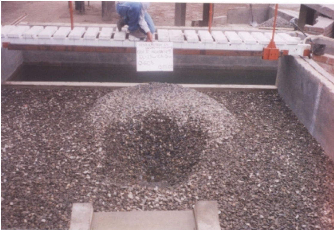
Foto N° 37: Fase II - Prueba 9: ( Q = 0.06 \text{ m}^3/\text{s} , h_{CA} = 0.05 \text{ m} , d_{50} = 17.88 \text{ mm} ). Vista de la poza de erosión después de dos horas de prueba. La profundidad de erosión fue de 0.347 \text{ m} .
