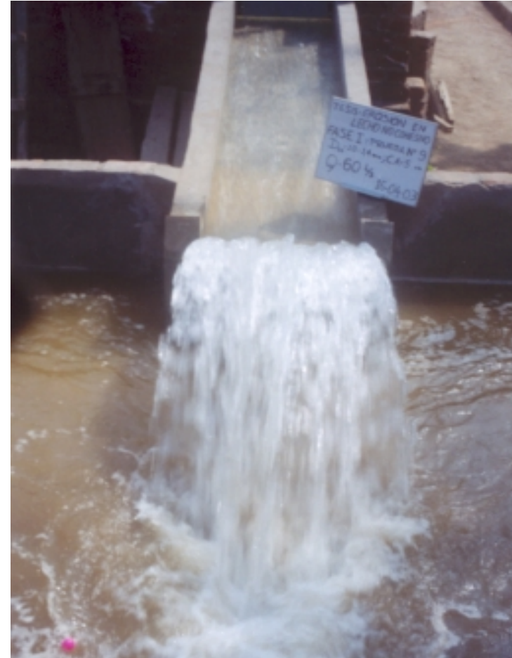
Foto N° 21: Fase I - Prueba 9. ( Q = 0.06 \text{ m}^3/\text{s} , h_{CA} = 0.05 \text{ m} , d_{50} = 1.60 \text{ mm} ) Se observa la bolita rosada, la cual indica que la erosión ha llegado a 20 cm de profundidad, aproximadamente.
