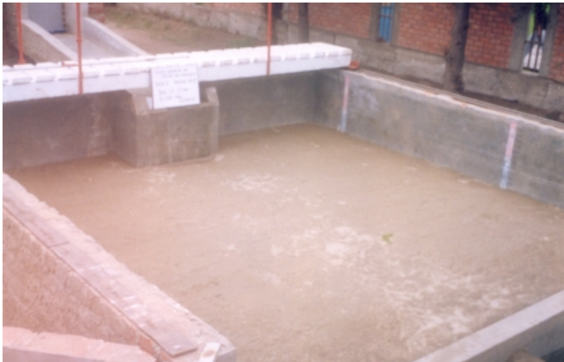
Foto N° 13: Fase I - Prueba 3. ( Q = 0.02 \text{ m}^3/\text{s} ; h_{CA} = 0.50 \text{ m} ; d_{50} = 1.60 \text{ mm} ) Vista del cuenco después de dos horas de prueba. No se produjo erosión.
