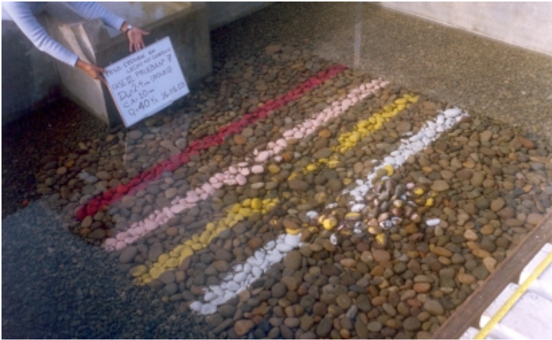
Foto N° 47: Fase III - Prueba 7: ( Q = 0.04 \text{ m}^3/\text{s} , h_{CA} = 0.10 \text{ m} , d_{50} = 49.08 \text{ mm} ). Vista de la poza de erosión después de dos horas de prueba. La profundidad de erosión fue de 0.217 \text{ m} .
