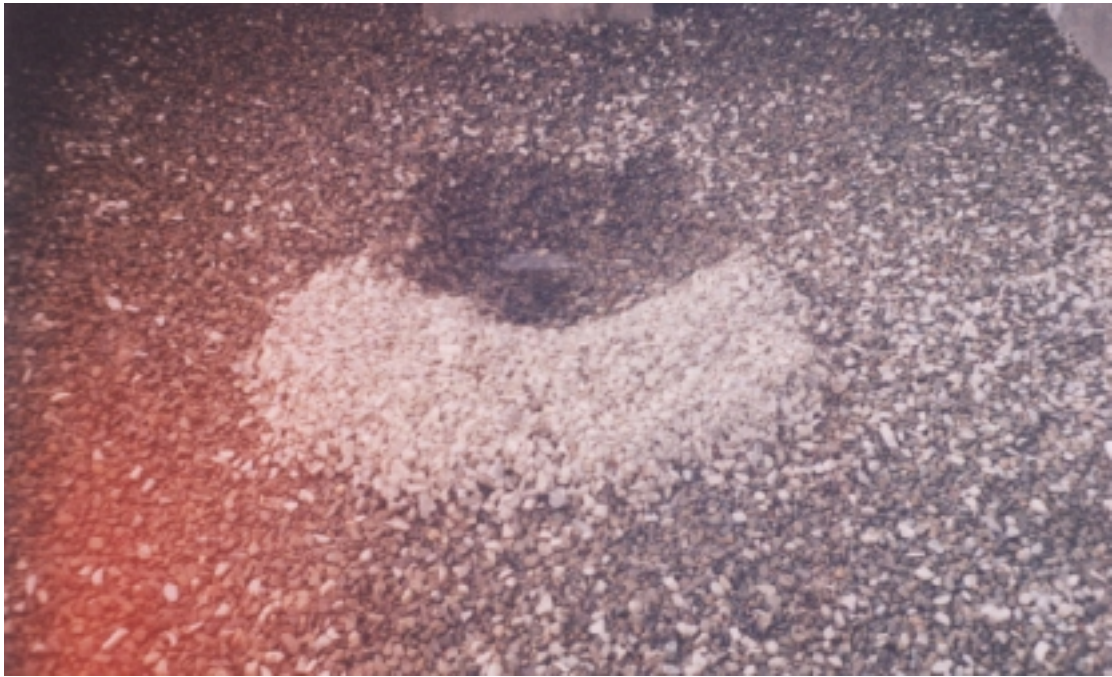
Foto N° 36: Fase II - Prueba 8: ( Q = 0.04 \text{ m}^3/\text{s} , h_{CA} = 0.25 \text{ m} , d_{50} = 17.88 \text{ mm} ). Vista de la poza de erosión después de dos horas de prueba. La profundidad de erosión fue de 0.162 \text{ m} .
