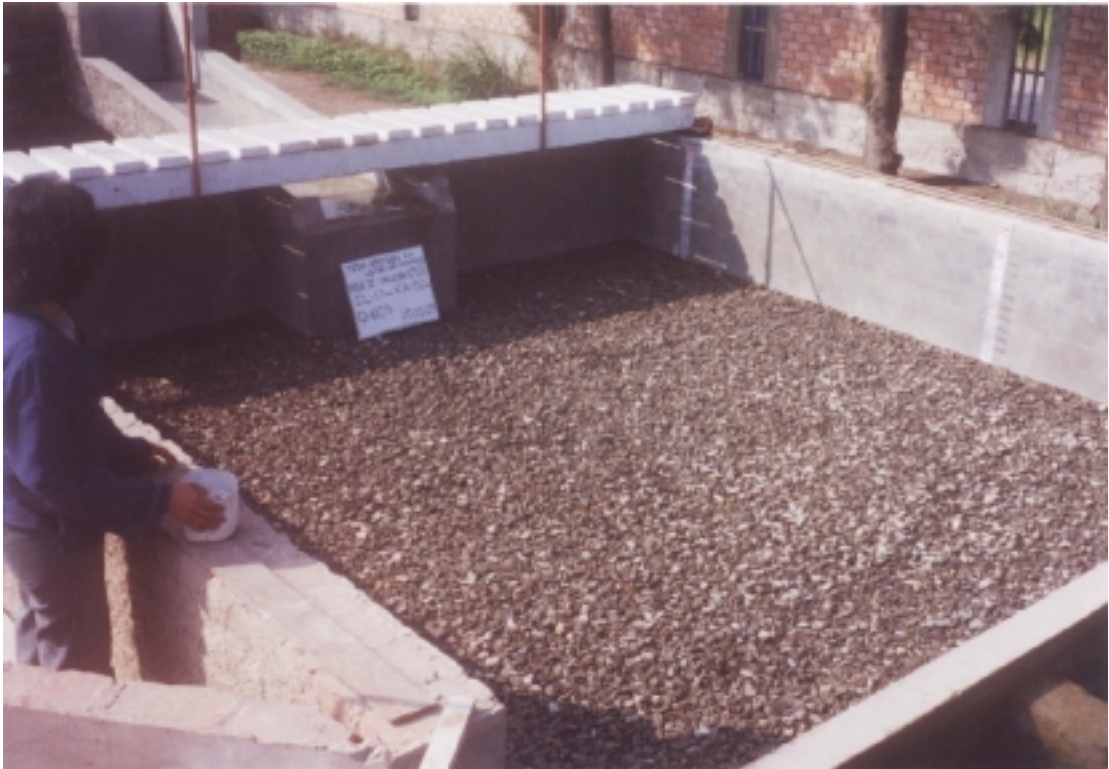
Foto N° 40: Fase II - Prueba 12: ( Q = 0.06 \text{ m}^3/\text{s} , h_{CA} = 0.50 \text{ m} , d_{50} = 17.88 \text{ mm} ). Vista del cuenco. Después de dos horas de prueba, no se produjo erosión.
