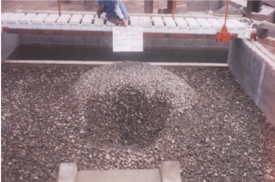
Foto N° 38: Fase II - Prueba 10: ( Q = 0.06 \text{ m}^3/\text{s} , h_{CA} = 0.10 \text{ m} , d_{50} = 17.88 \text{ mm} ). Vista de la poza de erosión después de dos horas de prueba. La profundidad de erosión fue de 0.352 m
