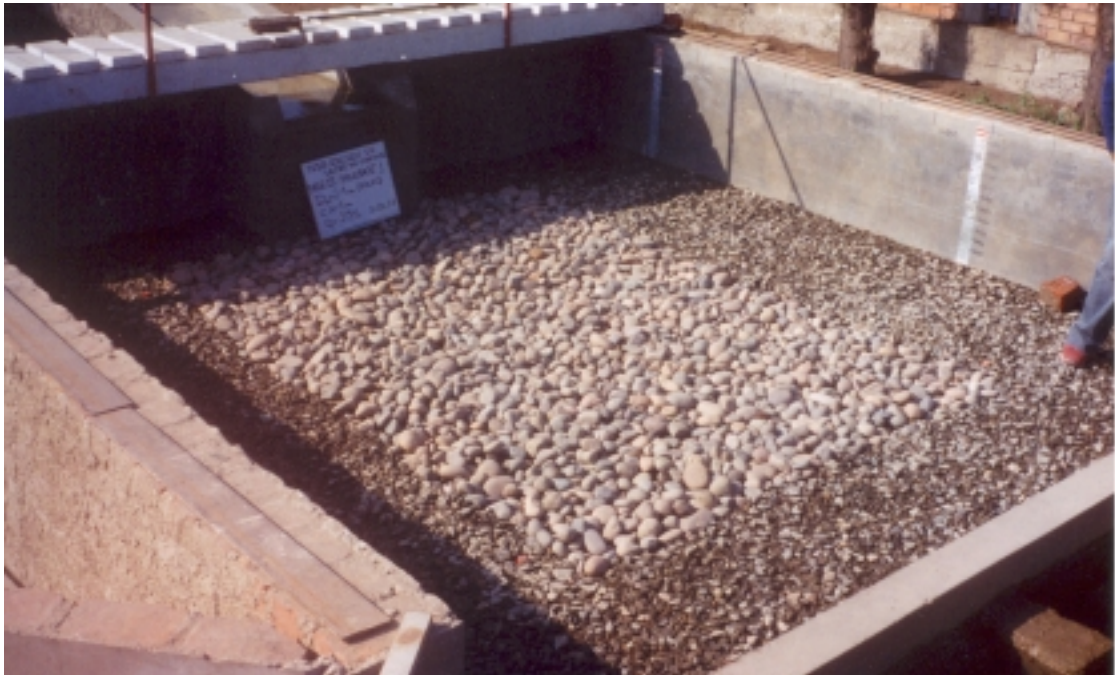
Foto N° 41: Fase III - Prueba 1: ( Q = 0.02 \text{ m}^3/\text{s} , h_{CA} = 0.05 \text{ m} , d_{50} = 49.08 \text{ mm} ). Vista de la poza de erosión después de dos horas de prueba. La profundidad de erosión fue de 0.06 m.
