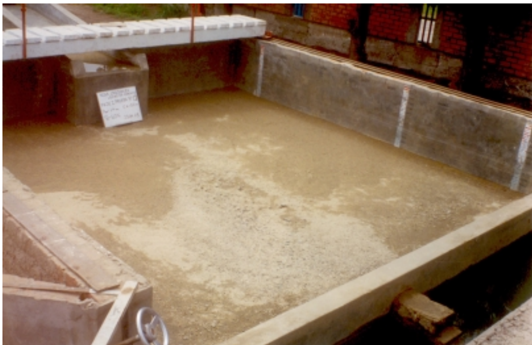
Foto N° 28: Fase I – Prueba 12. ( Q = 0.06 \text{ m}^3/\text{s} , h_{CA} = 0.5 \text{ m} , d_{50} = 1.60 \text{ mm} ) Vista de la erosión superficial que ha originado el chorro después de 2 horas de prueba. Esta fue de 0.076 m.
