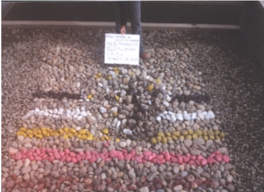
Foto 4.13: Fase III - Prueba 9 ( Q = 0.06 \text{ m}^3/\text{s} , h_{CA} = 0.05 \text{ m} d_{50} = 49.08 \text{ mm} y d_{85} = 70.53 \text{ mm} ). Vista de la poza de erosión, después de dos horas de prueba. La profundidad de erosión fue de 0.166 \text{ m} .
