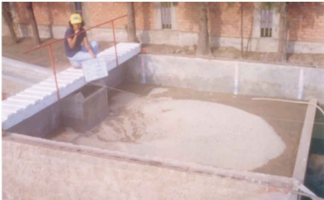
Foto N° 11: Fase I - Prueba N°1 ( Q = 0.02 \text{ m}^3/\text{s} , h_{CA} = 0.10 \text{ m} , d_{50} = 1,60 \text{ mm} ). Vista de la poza de erosión después de dos horas de prueba. La profundidad de erosión fue de 0.189 m
