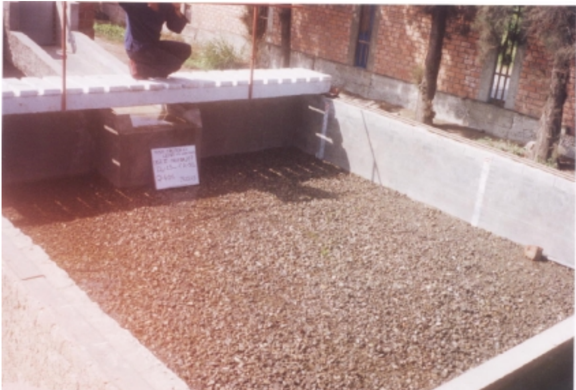
Foto N° 35: Fase II - Prueba 7: ( Q = 0.04 \text{ m}^3/\text{s} , h_{CA} = 0.50 \text{ m} , d_{50} = 17.88 \text{ mm} ) Vista de la poza de erosión después de dos horas de prueba. No se produjo erosión.
