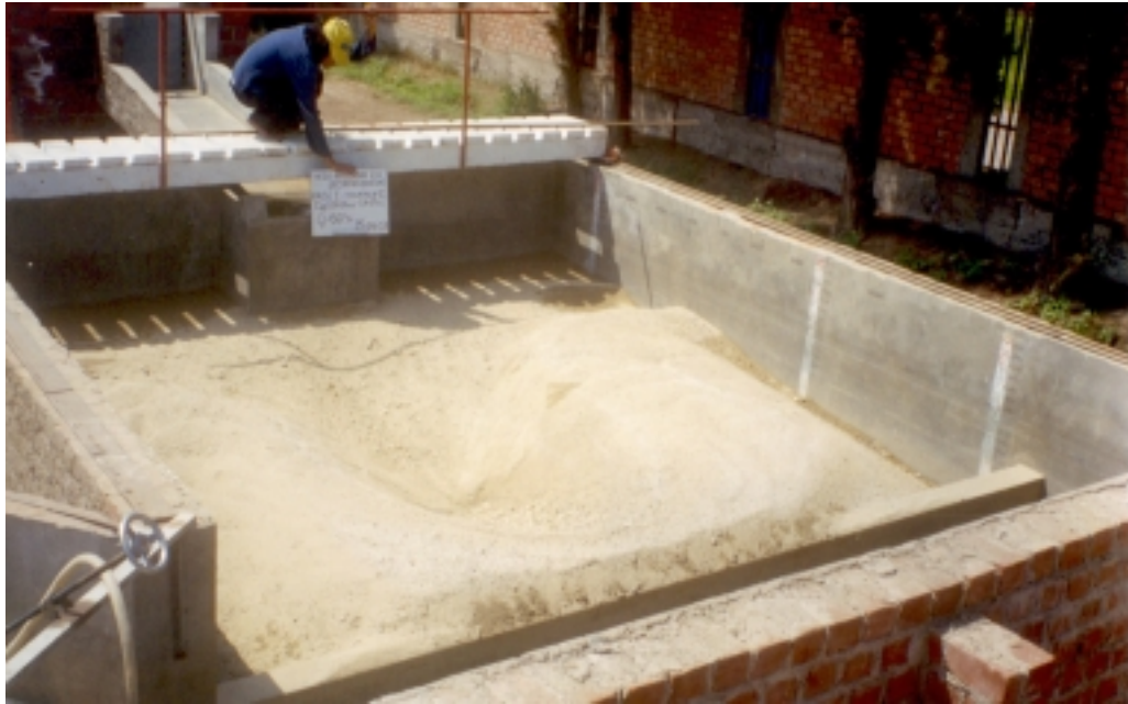
Foto 4.11: Fase I - Prueba 11( Q = 0.06 \text{ m}^3/\text{s} , h_{CA} = 0.25 \text{ m} , d_{50} = 1.60 \text{ mmy} d_{85} = 4.81 \text{ mm} ). Vista del pozo de erosión después de 2 horas de prueba. La profundidad de erosión fue de 0.349 m.
