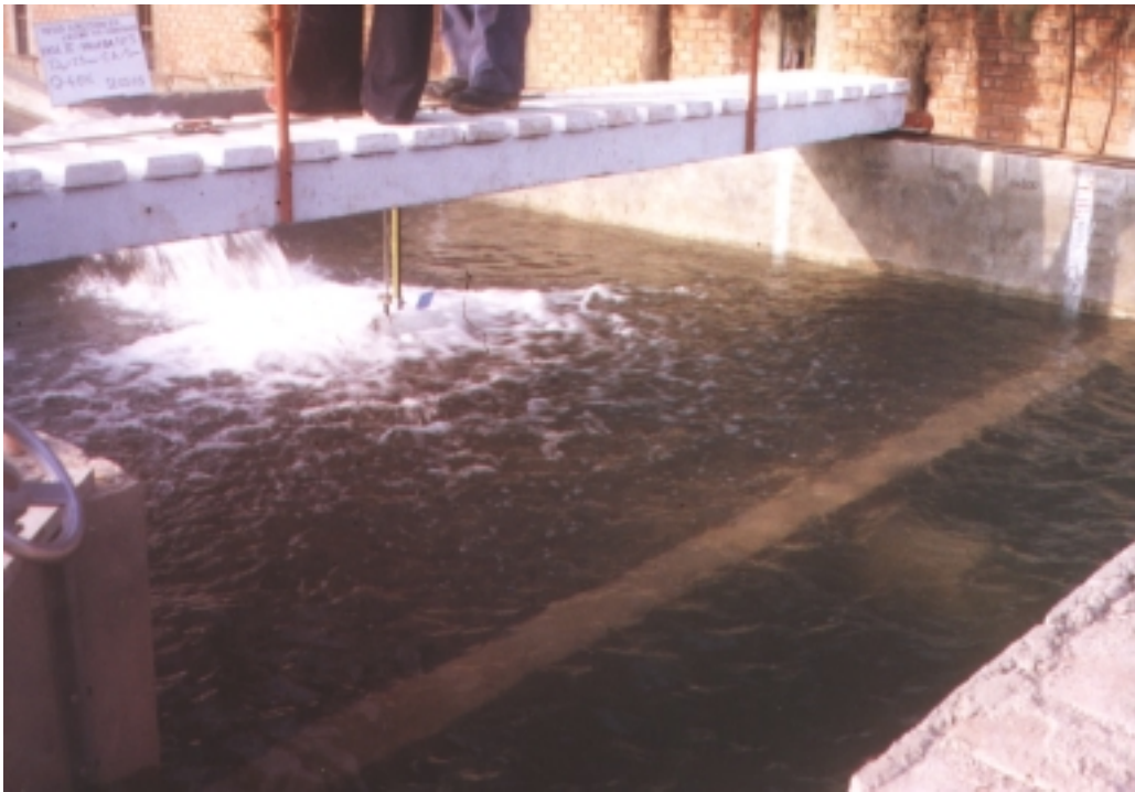
Foto 4.8: Fase II - Prueba 5. ( Q = 0.04 \text{ m}^3/\text{s} , h_{CA} = 0.05 \text{ m} , d_{50} = 17.88 y d_{85} = 23.43 \text{ mm} ). Vista de la toma de velocidad en la zona de impacto (en el eje).
