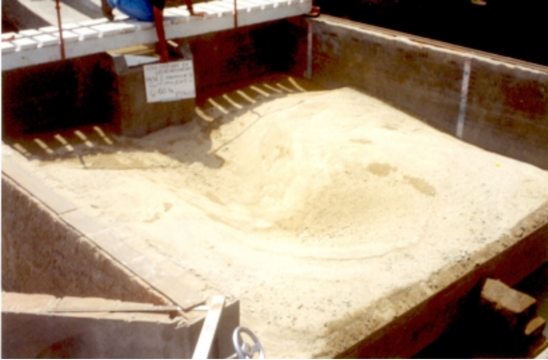
Foto N° 22: Fase I - Prueba 9. ( Q = 0.06 \text{ m}^3/\text{s} , h_{CA} = 0.05 \text{ m} , d_{50} = 1.60 \text{ mm} ). Vista del pozo de erosión después de 2 horas de prueba. La profundidad de erosión fue de 0.389 m.
