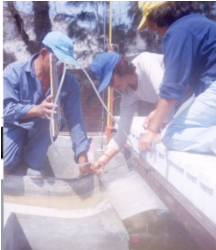
Foto N° 17: Fase I – Prueba 7. ( Q = 0.04 \text{ m}^3/\text{s} , h_{CA} = 0.25 \text{ m} , d_{50} = 1.60 \text{ mm} ). Se observa la toma de datos de velocidad en el ski, con el Tubo de Pitot.
