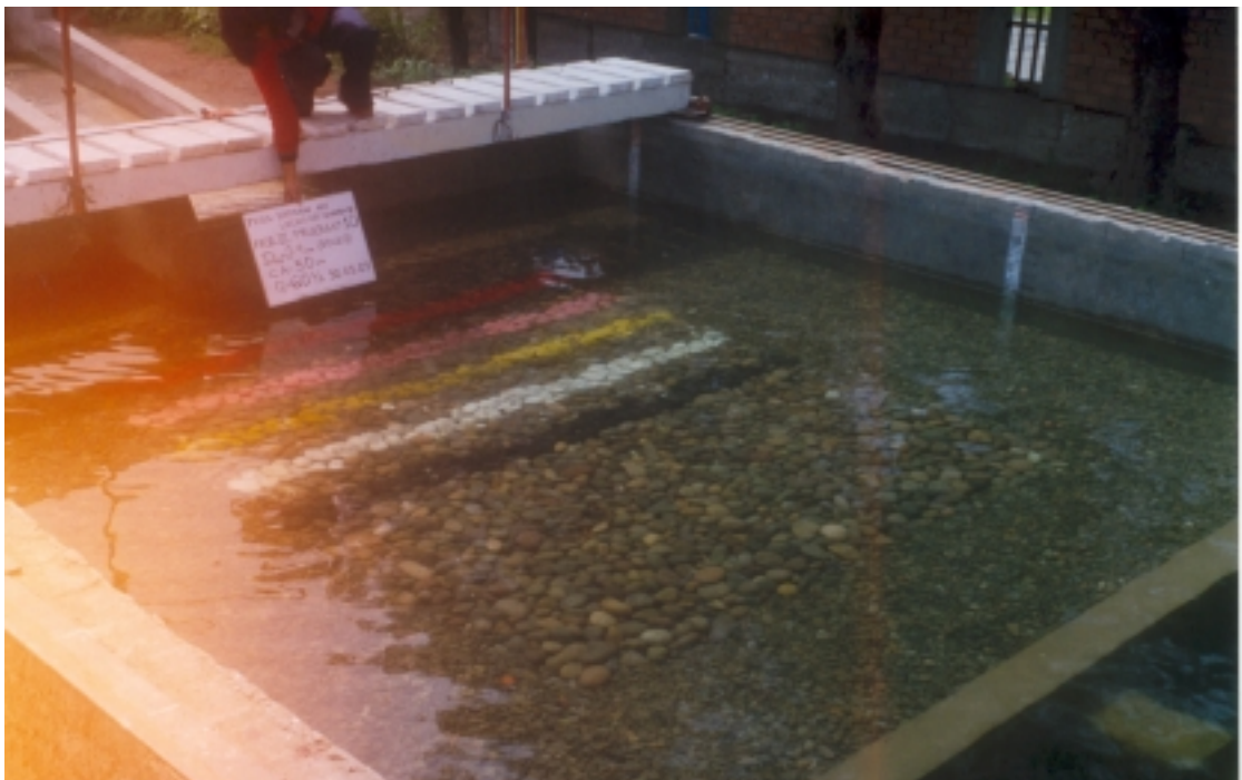
Foto N° 50: Fase III - Prueba 10: ( Q = 0.06 \text{ m}^3/\text{s} , h_{CA} = 0.50 \text{ m} , d_{50} = 49.08 \text{ mm} ). Vista del cuenco después de dos horas de prueba. No se produjo erosión.
