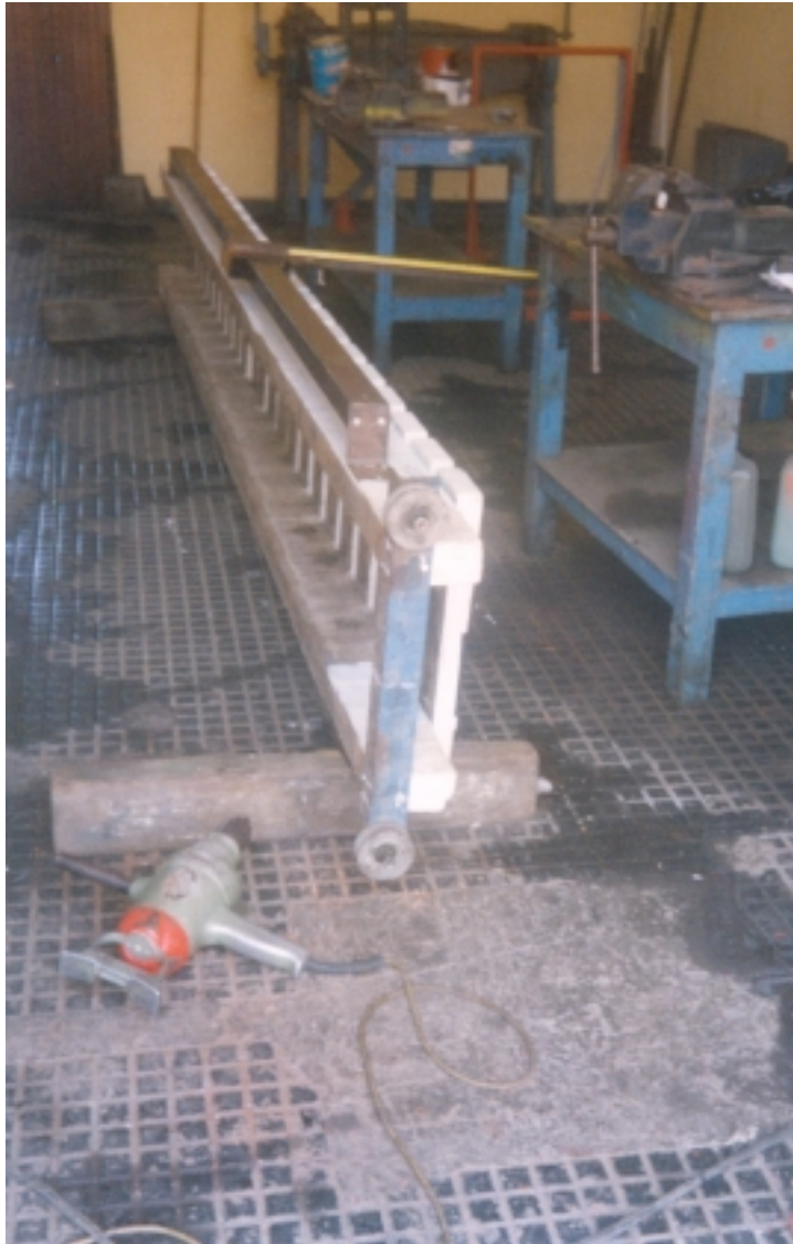
Foto N° 07: Vista del puente corredizo. A este se le acoplará el correntómetro, el cual nos permitirá medir las velocidades en distintas coordenadas del cuenco.
