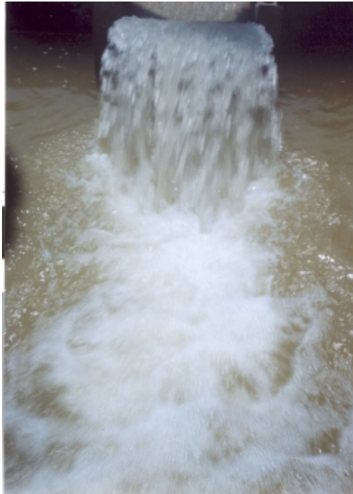
Foto N° 18: Fase I - Prueba 7. ( Q = 0.04 \text{ m}^3/\text{s} , h_{CA} = 0.25 \text{ m} , d_{50} = 1.60 \text{ mm} ) Vista del impacto del chorro con el colchón de agua. Se produce una turbulencia total, en la cual este pierde energía.
