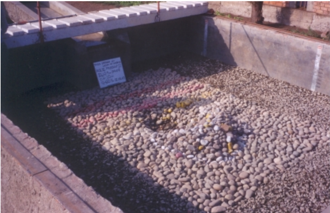
Foto N° 52: Fase III - Prueba 12: ( Q = 0.06 \text{ m}^3/\text{s} , h_{CA} = 0.10 \text{ m} , d_{50} = 49.08 \text{ mm} ). Vista de la poza de erosión después de dos horas de prueba. La profundidad de erosión fue de 0.171 \text{ m} .
