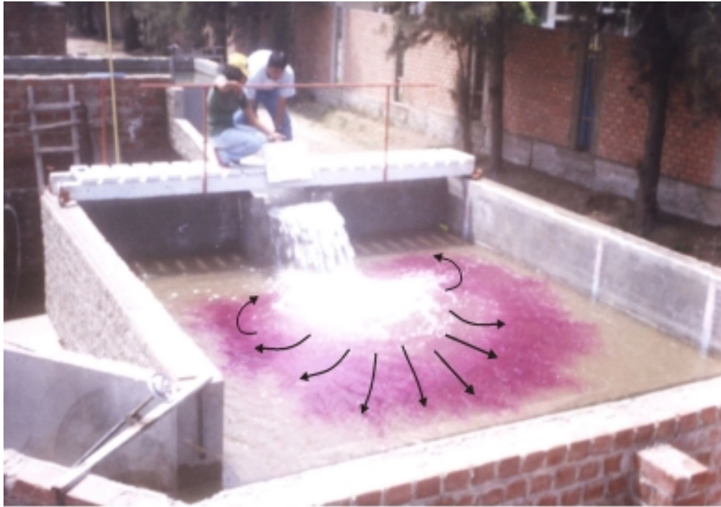
Foto 4.9: Fase I - Prueba 10 ( Q = 0.06 \text{ m}^3/\text{s} , h_{CA} = 0.10 \text{ m} , d_{50} = 1.60 \text{ mm} y d_{85} = 4.81 \text{ mm} ). Se observa la distribución de las líneas de corriente en el momento del impacto del chorro con el colchón de agua.
