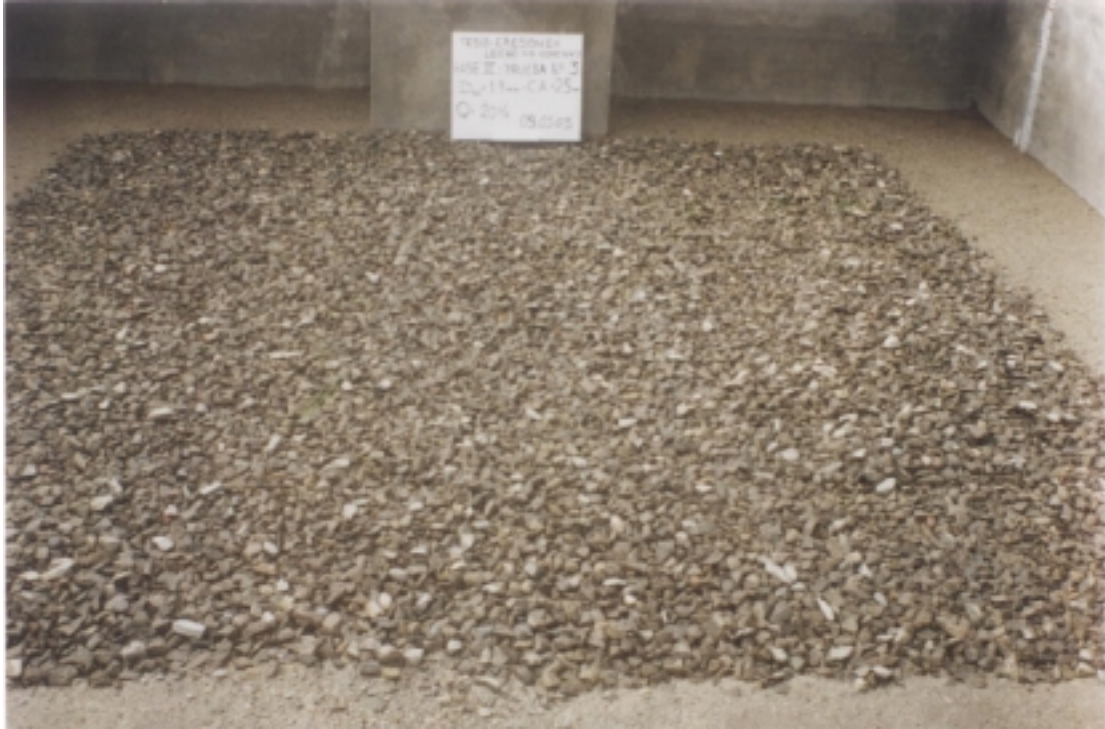
Foto N° 32: Fase II - Prueba 3 y 4 : ( Q = 0.02 \text{ m}^3/\text{s} , h_{CA} = 0.25 \text{ m} y 0.50 \text{ m} , d_{50} = 17.88 \text{ mm} ). Vista de la poza de erosión, después de dos horas de prueba. No hubo proceso de erosión.
