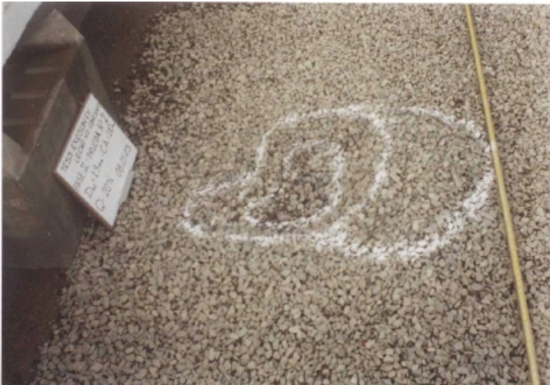
Foto N° 31: Fase II - Prueba 2: ( Q = 0.02 \text{ m}^3/\text{s} , h_{CA} = 0.10 \text{ m} , d_{50} = 17.88 \text{ mm} ). Vista de la poza de erosión, después de dos horas de prueba. La profundidad de erosión fue de 0.150 m.
