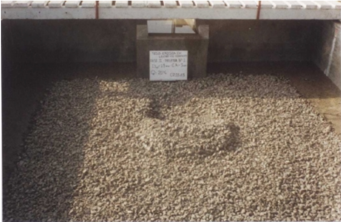
Foto N° 30: Fase II - Prueba 1: ( Q = 0.02 \text{ m}^3/\text{s} , h_{CA} = 0.05 \text{ m} , d_{50} = 17.88 \text{ mm} ). Vista de la poza de erosión después de dos horas de prueba. La profundidad fue de 0.155 m.
