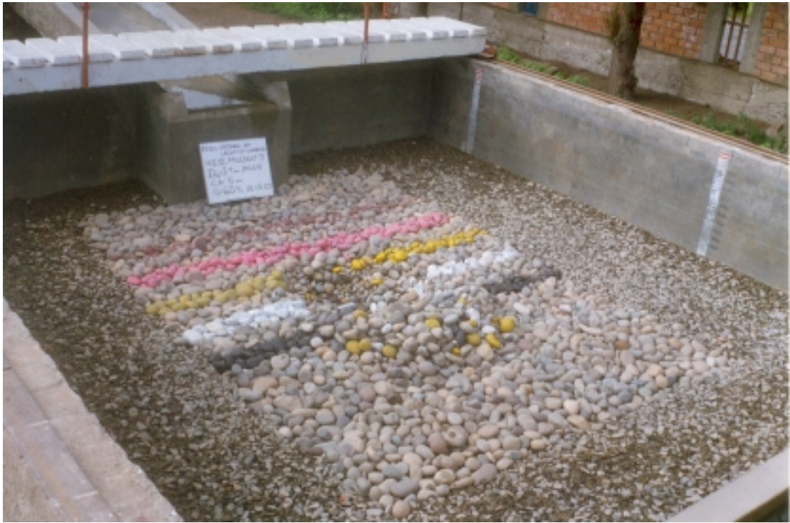
Foto N° 49: Fase III - Prueba 9: ( Q = 0.06 \text{ m}^3/\text{s} , h_{CA} = 0.05 \text{ m} , d_{50} = 49.08 \text{ mm} ). Vista de la poza de erosión después de dos horas de prueba. La profundidad de erosión fue de 0.166 \text{ m} .
