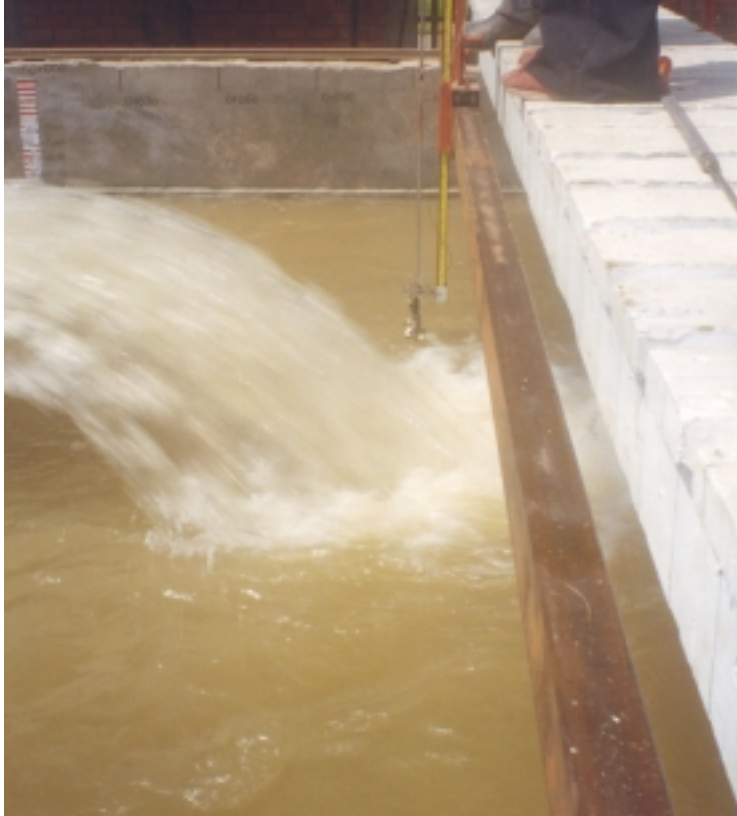
Foto N° 25: Fase I - Prueba 11. ( Q = 0.06 \text{ m}^3/\text{s} , h_{CA} = 0.25 \text{ m} , d_{50} = 1.60 \text{ mm} ) Vista de la toma de velocidad en la zona de impacto (sección 0+120 y en -0.60 cm del eje).
