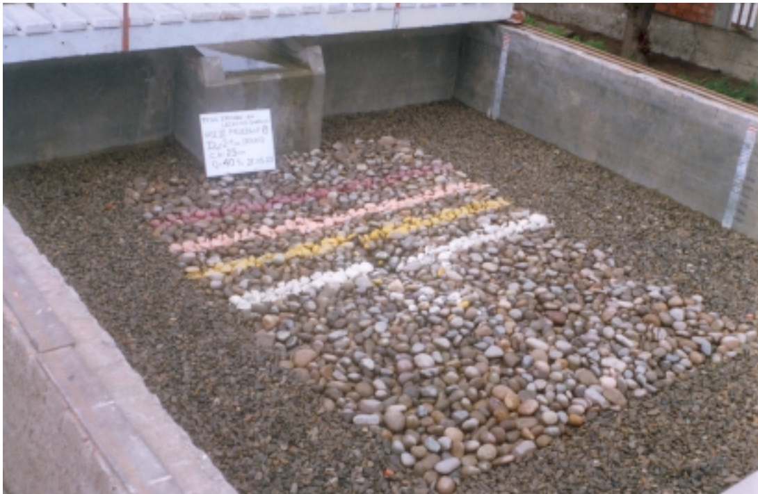
Foto N° 48: Fase III - Prueba 8: ( Q = 0.04 \text{ m}^3/\text{s} , h_{CA} = 0.25 \text{ m} , d_{50} = 49.08 \text{ mm} ). Vista de la poza de erosión después de dos horas de prueba. La profundidad de erosión fue de 0.062 \text{ m} .
