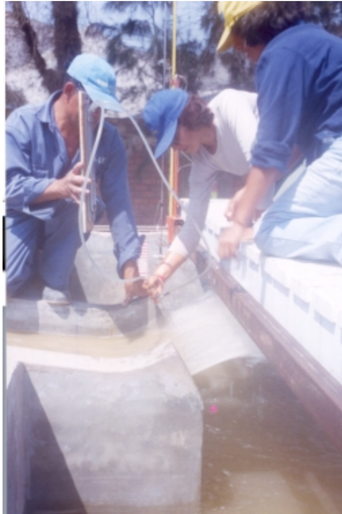
Foto 4.10: Fase I – Prueba 7 ( Q = 0.04 \text{ m}^3/\text{s} , h_{CA} = 0.25 \text{ m} , d_{50} = 1.60 \text{ mm} y d_{85} = 4.81 \text{ mm} ). Toma de datos de velocidad en el labio del ski, con el Tubo de Pitot, en tres ejes en planta y en cada eje a dos profundidades.
