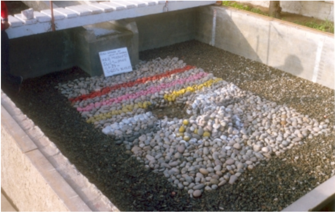
Foto N° 51: Fase III - Prueba 11: ( Q = 0.06 \text{ m}^3/\text{s} , h_{CA} = 0.25 \text{ m} , d_{50} = 49.08 \text{ mm} ). Vista de la poza de erosión después de dos horas de prueba. La profundidad de erosión fue de 0.128 \text{ m} .
