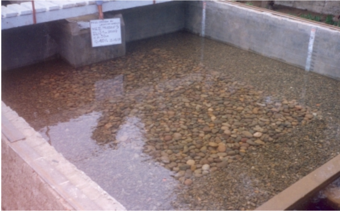
Foto N° 45: Fase III - Prueba 5: ( Q = 0.04 \text{ m}^3/\text{s} , h_{CA} = 0.50 \text{ m} , d_{50} = 49.08 \text{ mm} ). Vista del cuenco después de dos horas de prueba. No se produjo erosión.
