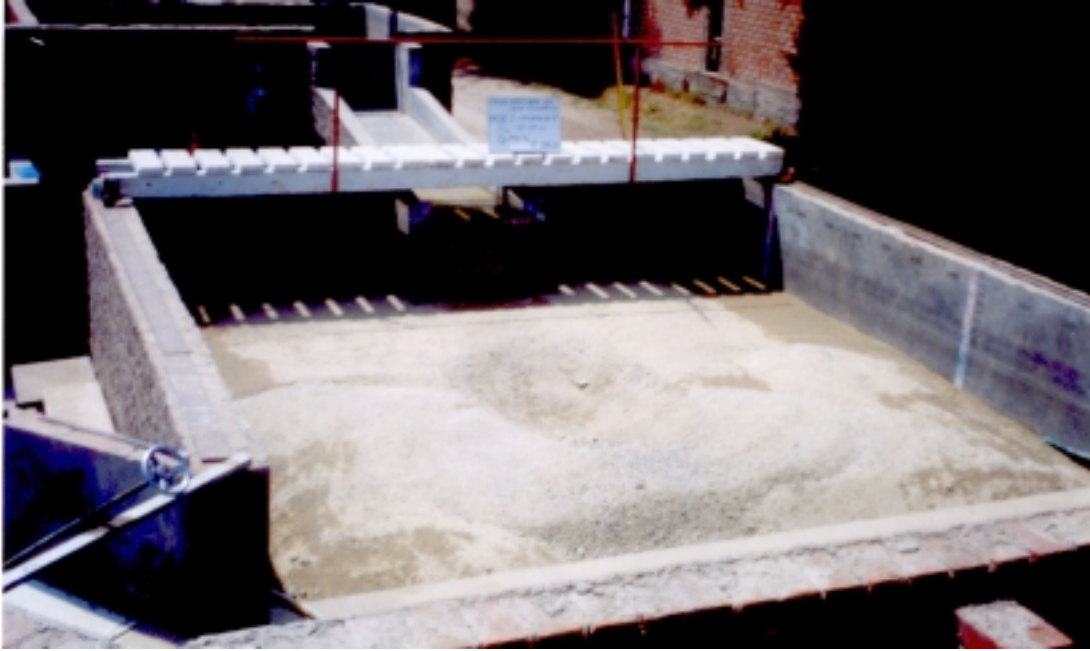
Foto N° 16: Fase I - Prueba 7. ( Q = 0.04 \text{ m}^3/\text{s} , h_{CA} = 0.25 \text{ m} , d_{50} = 1.60 \text{ mm} ) La profundidad de erosión en esta prueba, después de dos horas de prueba, fue de 0.245 m.
