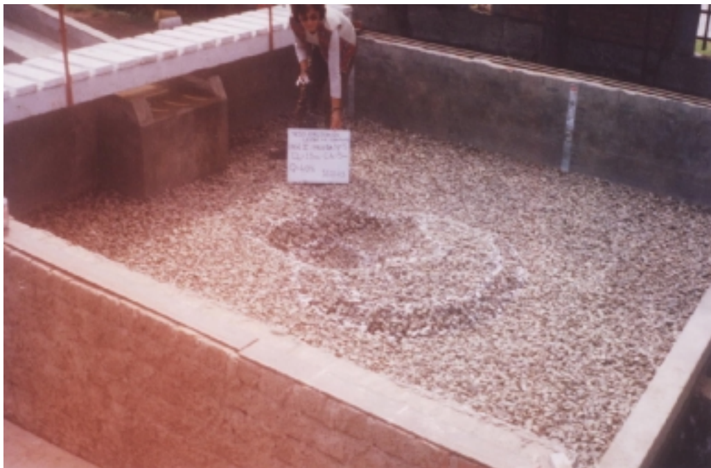
Foto 4.12: Fase II - Prueba 5. ( Q = 0.04 \text{ m}^3/\text{s} , h_{CA} = 0.05 \text{ m} , d_{50} = 17.88 \text{ mm} y d_{85} = 23.43 \text{ mm} ). Vista de la poza de erosión, después de dos horas de prueba. La profundidad de erosión fue de 0.273 m.
