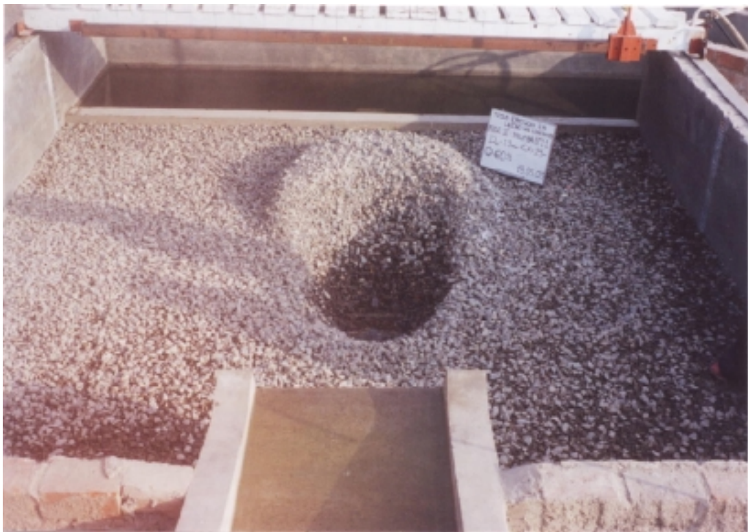
Foto N° 39: Fase II - Prueba 11: ( Q = 0.06 \text{ m}^3/\text{s} , h_{CA} = 0.25 \text{ m} , d_{50} = 17.88 \text{ mm} ). Vista de la poza de erosión después de dos horas de prueba. La profundidad de erosión fue de 0.30 m.
