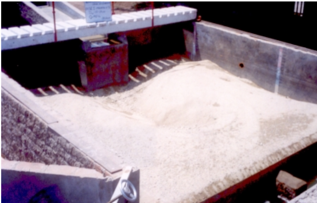
Foto N° 15: Fase I - Prueba 5. ( Q = 0.04 \text{ m}^3/\text{s} ; h_{CA} 0.05 \text{ m} ; d_{50} = 1.60 \text{ mm} ) Se observa la poza de erosión después de dos horas de prueba. La profundidad de erosión fue de 0.309 \text{ m} . De modo similar fue para la Prueba 6, siendo la profundidad de erosión de 0.301 \text{ m}
