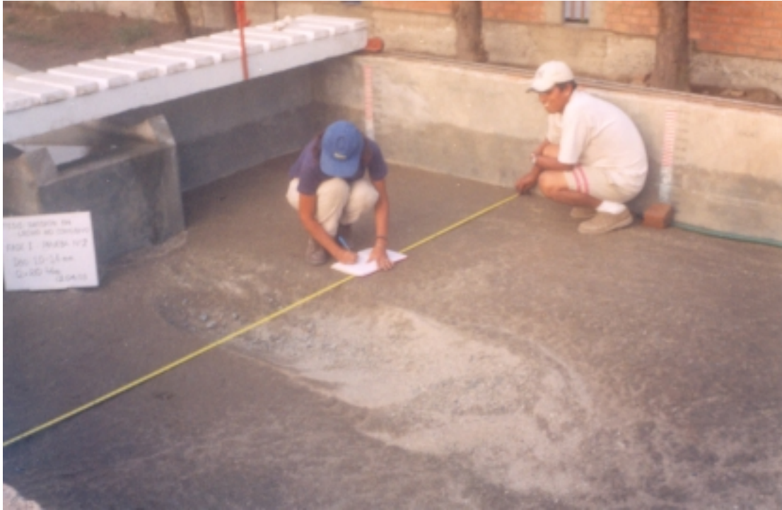
Foto N° 12: Fase I - Prueba 2. ( Q = 0.02 \text{ m}^3/\text{s} ; h_{CA} = 0.25 \text{ m} ; d_{50} = 1.60 \text{ mm} ). Vista del pozo de erosión después de dos horas de prueba. La profundidad de esta fue de 0.115 \text{ m}
