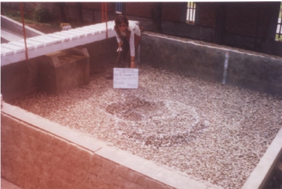
Foto N° 33: Fase II - Prueba 5: ( Q = 0.04 \text{ m}^3/\text{s} , h_{CA} = 0.05 \text{ m} , d_{50} = 17.88 \text{ mm} ). Vista de la poza de erosión, después de dos horas de prueba. La profundidad de erosión fue de 0.273 \text{ m} .
