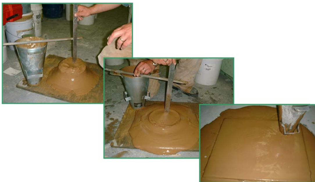
Figura 3. 17: Asentamiento de cono según consistencia de material. Tomado de Australian Government (2007: 54)
