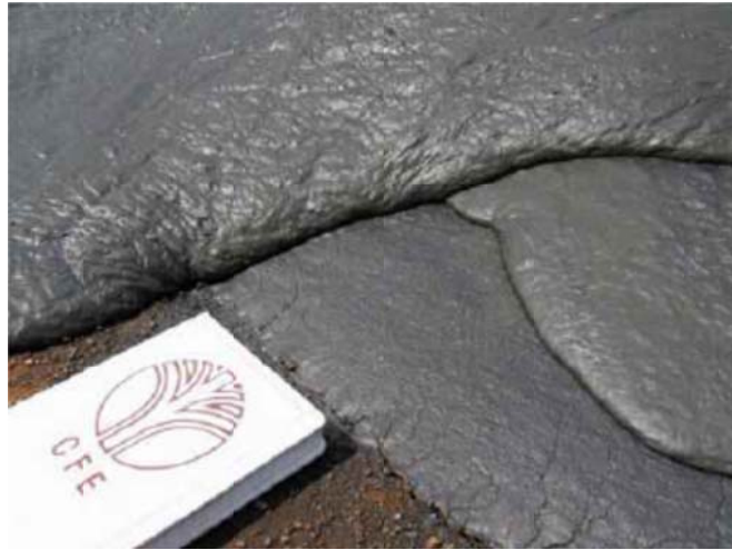
Figura 1. 2: Avance laminar de pasta en Bulyanhulu. Tomado de Golder PasteTec (2005e: 4)
