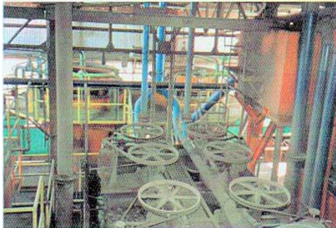
Foto NO.22 Vista panorámica de las celdas de flotación. Al fondo se aprecian las dos celdas columna.
