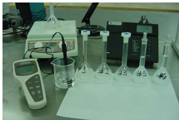
Figura 40. Matraces volumétricos conteniendo diferentes fracciones de volumen de sílice estando en suspensión de un electrolito a una concentración definida.
