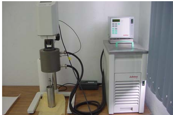
Figura 42. Cilindro concéntrico conteniendo la suspensión de sílice momento antes de colocarlo dentro del reómetro Rheolab.
