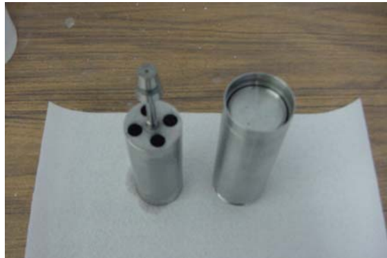
Figura 41. Cilindro concéntrico conteniendo la suspensión de sílice.
