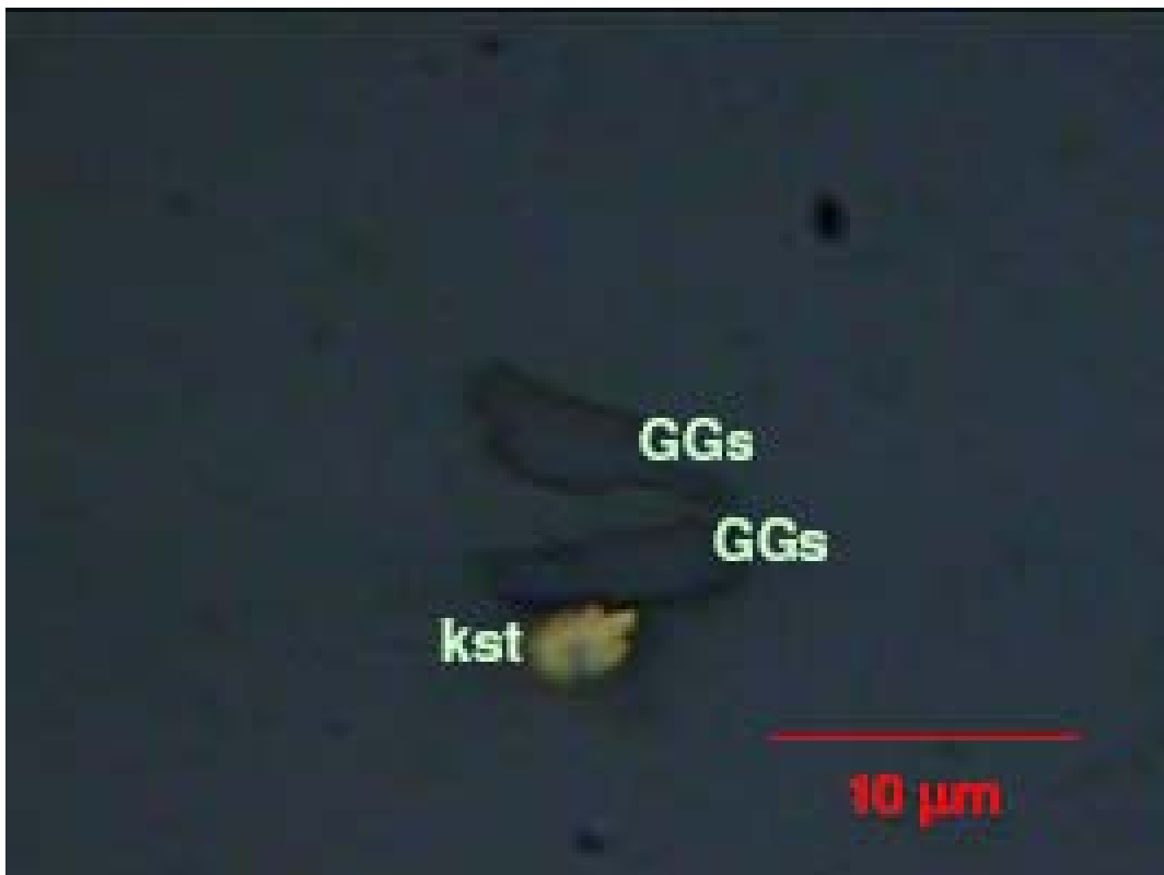
Malla +500 (lavado).- Gangas y kustelita libres. Obsérvese el pequeño tamaño de las partículas
