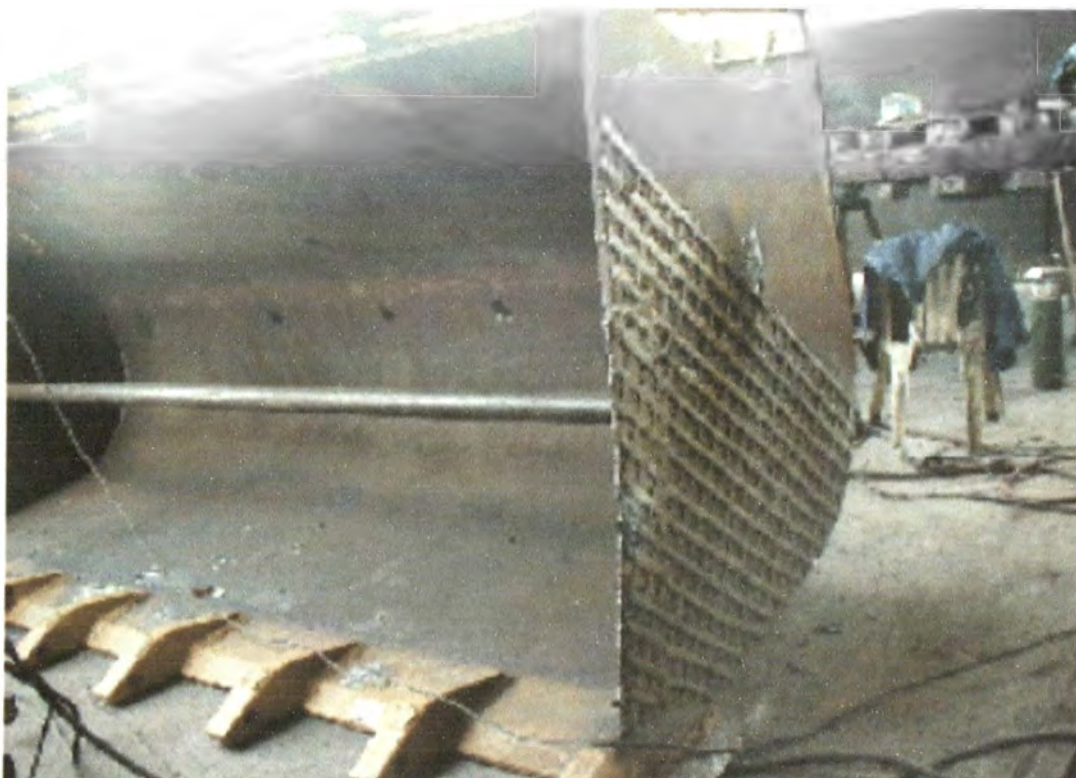
Figura 3.14 Protección de pared lateral de cucharón de cargador frontal
