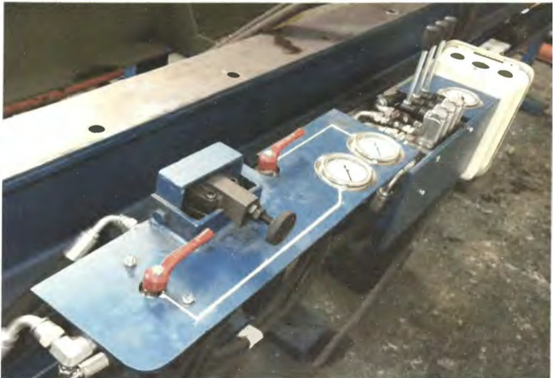
Fig. 5.8 Módulo de control del banco de IMPROMEC SRL.
