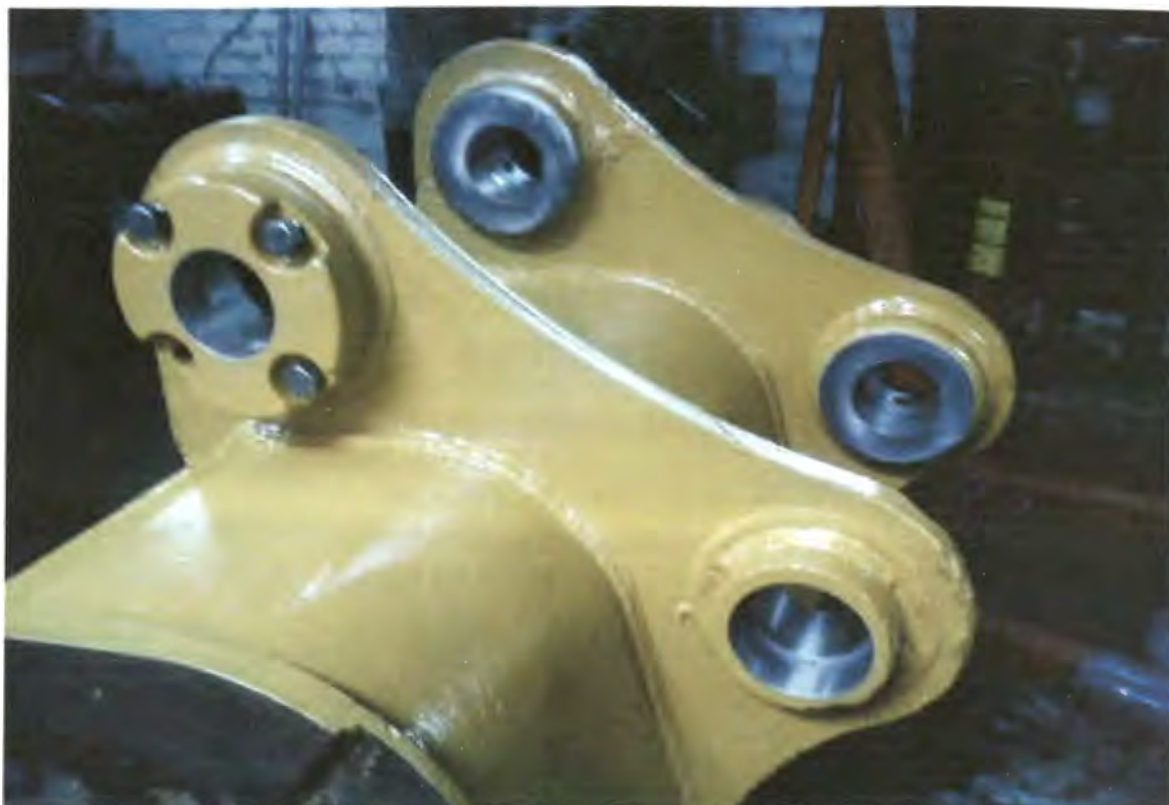
Figura 4.8 Acabado de alojamientos barrenados
