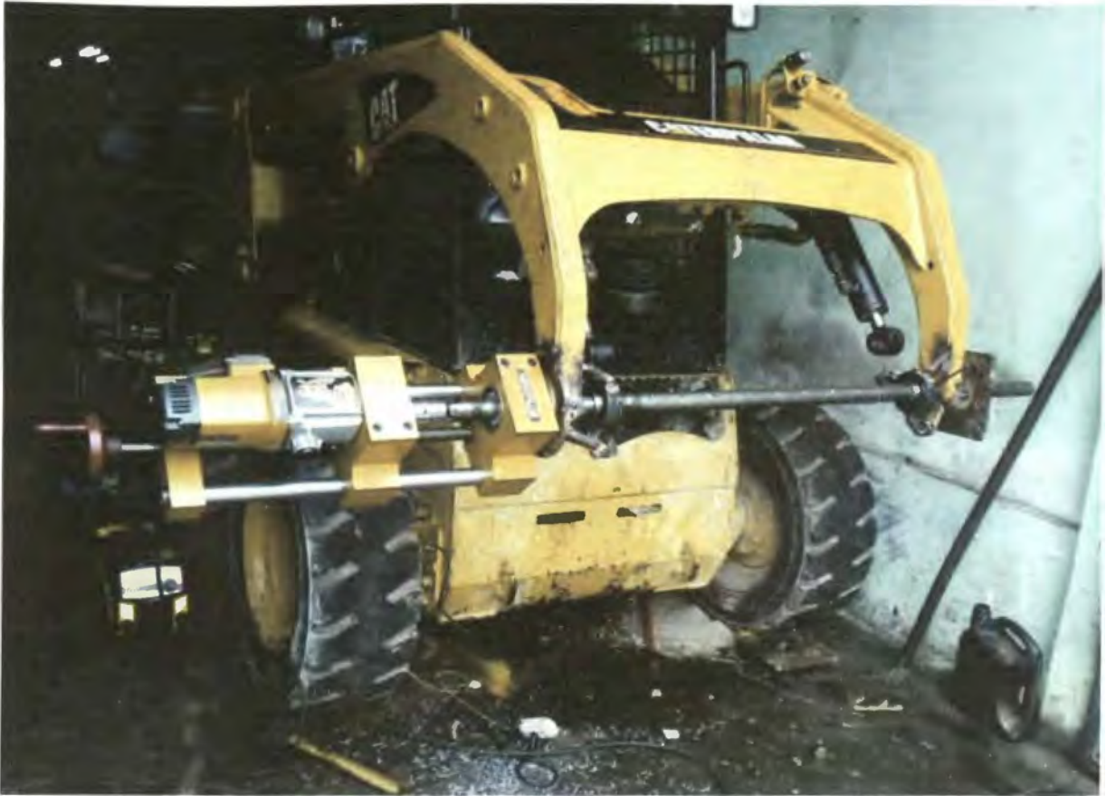
Figura 4.3 Barrenadora portátil instalada en brazo de mini cargador.
