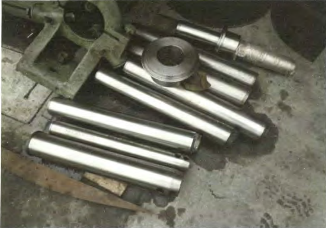
Figura 4.4 Recuperación de pines mediante soldadura y maquinado
