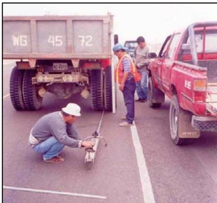
Foto 3.2. Medición de Deflexiones con Viga Benkelman.
