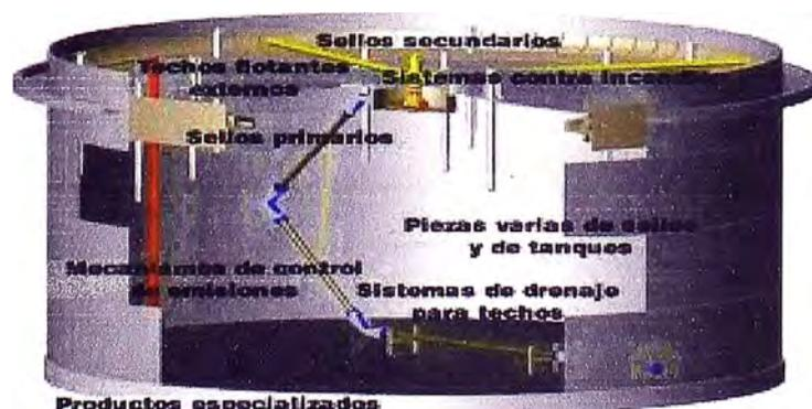
Figura N° 3.1: Esquema típico de un tanque de techo flotante
